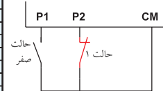
شکل ۲۵- منظور از صفر یعنی ورودی بدون ولتاژ و منظور از یک یعنی ورودی با ولتاژ (ورودی باز و بسته)
