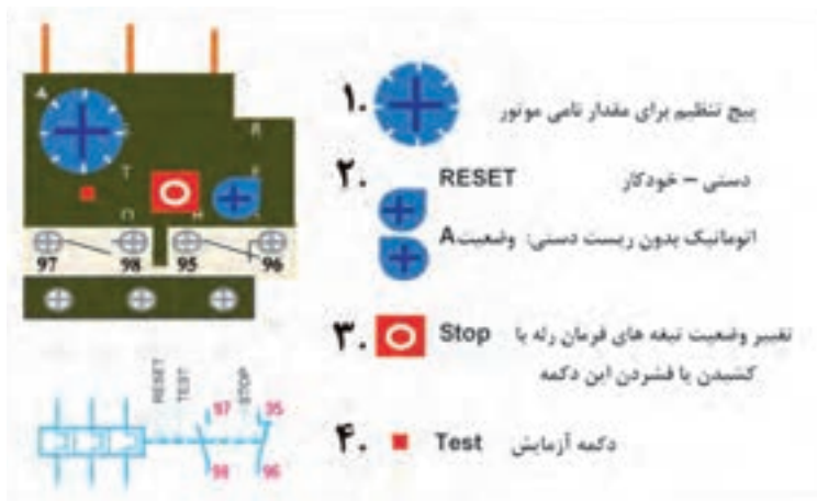
شکل ۵-الف) تنظیم رله اضافه بار یا بی‌متال
