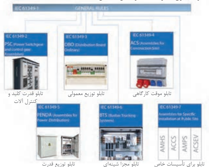
شکل ۳- دسته بندی انواع تابلوهای برق فشار ضعیف
