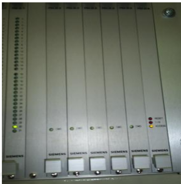
به ترتیب از راست: کارت expansion و کارت‌های command
