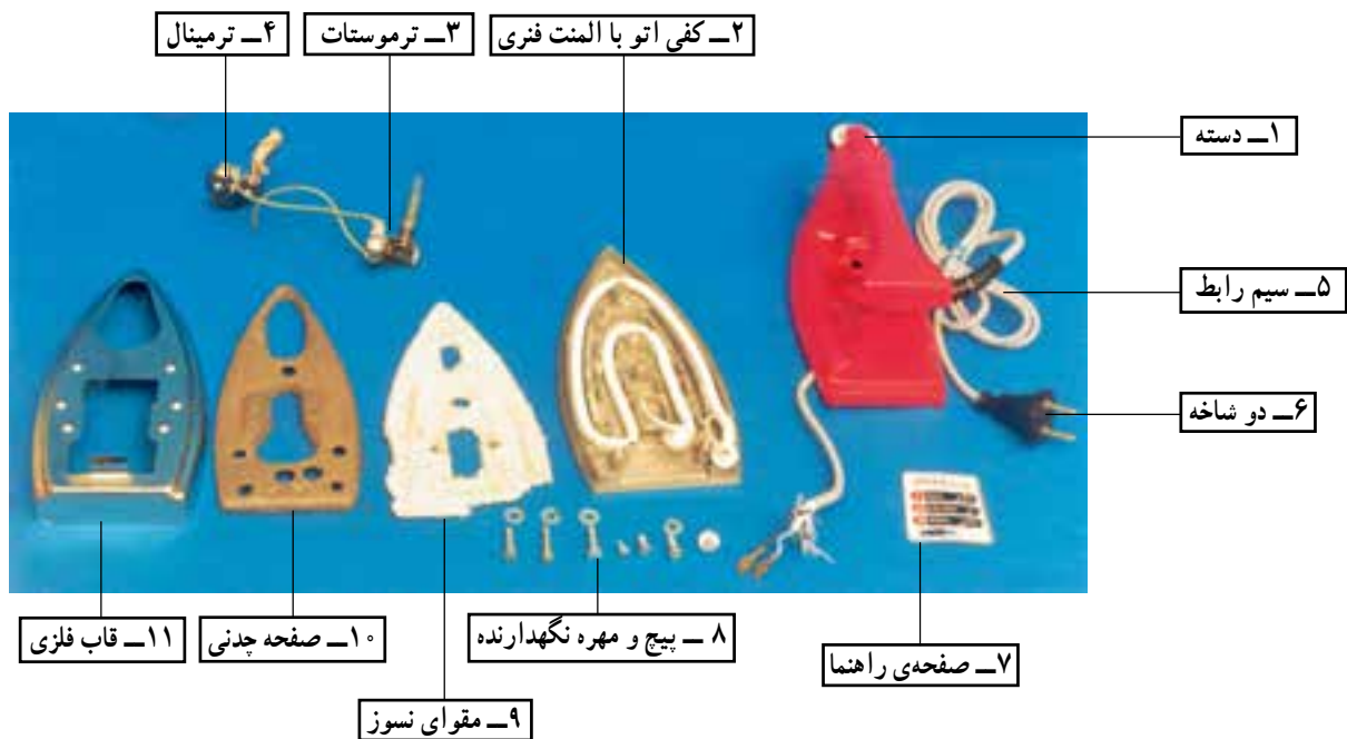
شکل ۷۷-۵- اجزای ساختمانی یک نمونه اتوی برقی
