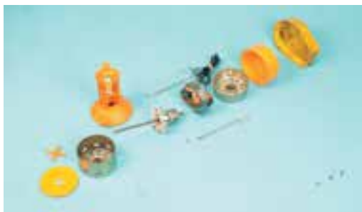
شکل ۸-۱۸ - نمایش ظاهری و اجزای یک واترپمپ
