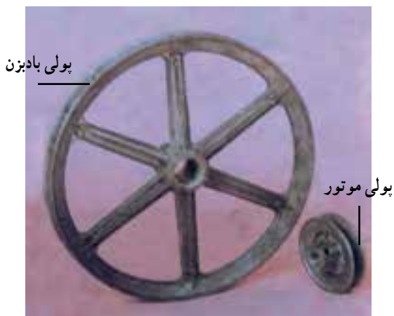
شکل ۸-۱۱ - پولی‌های موتور و فن
