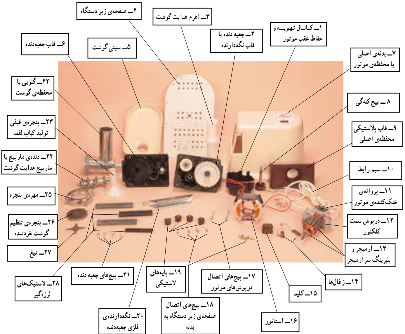
شکل ۳-۴۸- اجزای ساختمانی یک نمونه چرخ گوشت
