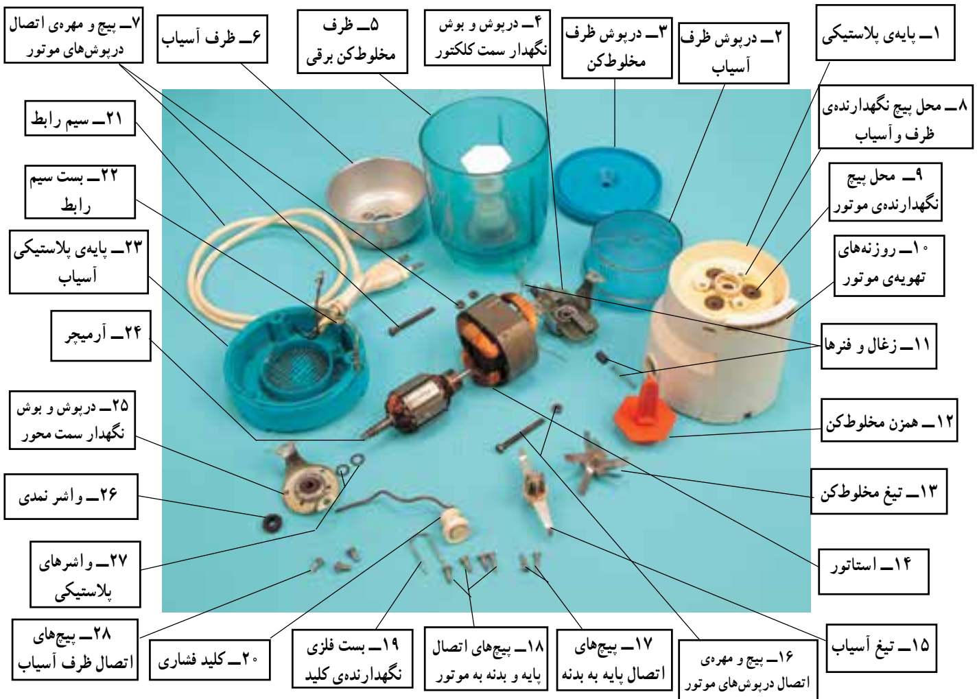
شکل ۴-۳۲- اجزای ساختمانی یک نمونه مخلوط‌کن برقی
