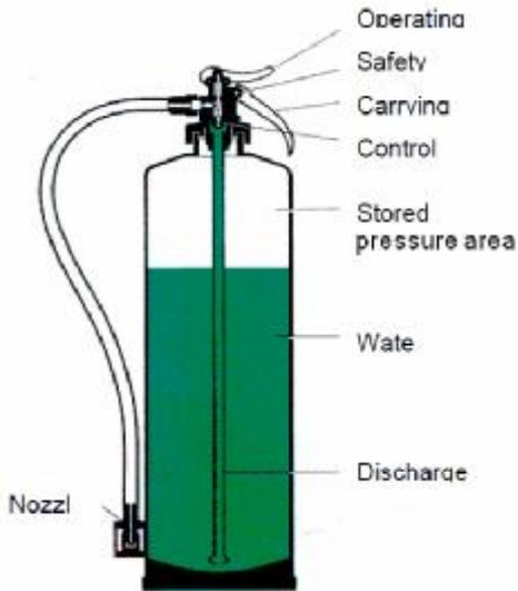
هوا یا گاز نیتروژن بوسیله ی یک تبدیل روی سر آن به درون آن تزریق می شود تا فشار درون سیلندر به ۱۰ بار برسد. برداشتن یک پین یا در پوش و فشار آوردن روی اهرم، خاموش کننده را به کار می اندازد. این عمل باعث باز شدن ولو می شود و به آب تحت فشار اجازه ی خروج می دهد. اهرم می تواند عمل تخلیه را کنترل کند.
