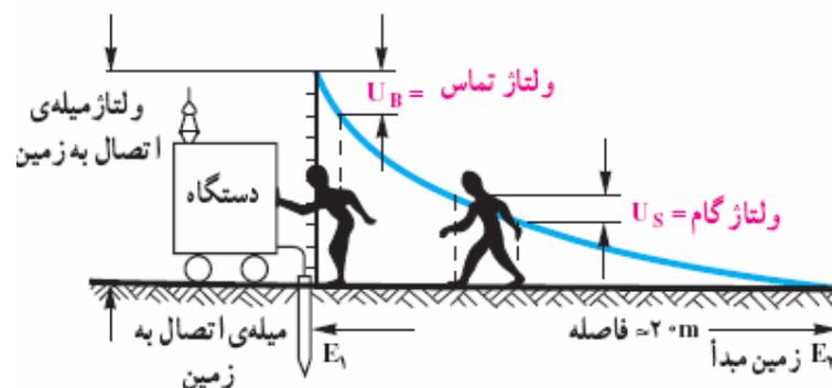
با توجه به شکل بالا ، هر چه از محل اتصال، دور شویم پتانسیل الکتریکی کم تر می شود و در فاصله ی تقریباً  $20$  متری به صفر می رسد. چنان چه شخصی در داخل دایره ای به مرکز نقطه ی اتصال سیم فاز به زمین و به شعاع
