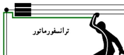
هر چه مقدار جریان عبوری از بدن زیادتر شود، خطر مرگ ناشی از برق گرفتگی بیش تر می شود. ولتاژ تماس عبارت است از :
