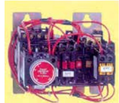
۱-۲۶۳(b) تایمربادی پنوماتیکی نصب شده روی کنتاکتور
