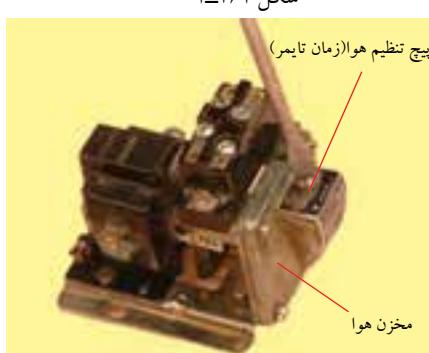
در این رله با تغییر پیچ روی مخزن هوا می‌توان سرعت پرشدن مخزن را کم و زیاد کرد و در فرستادن زمان تایmer، تأخیر یا سرعت به وجود آورد (شکل ۱-۲۶۲).
