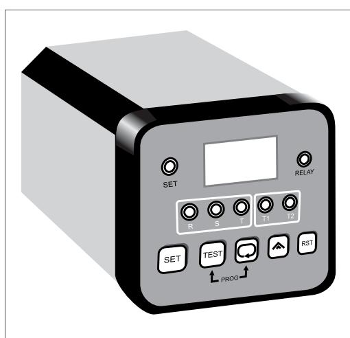
این زمان دو رله متناسب با توان موتور بین ۱ تا ۳۰ ثانیه قابل تنظیم است. اگر پس از پایان راه اندازی هنوز اضافه جریانی وجود داشته باشد نشان دهنده آن است که روی محور موتور اضافه بار وجود دارد در نتیجه رله متناسب با زمان تنظیمی روی آنها که معمولاً  $4\frac{1}{2}$ ،  $6$ ، ... ثانیه است مدار را قطع می‌کند. در شکل (۱-۲۸۲) تصویر ظاهری و مدار داخلی یک نمونه رله اضافه بار که دارای صفحه نمایش (LCD) است نشان داده شده است.
