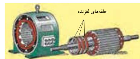
شکل ۱-۴۶-۱- اجزای موتور روتور سیم‌پیچی
