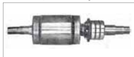
شکل ۱-۱۵- شکل واقعی روتور سیم پیچی شده
