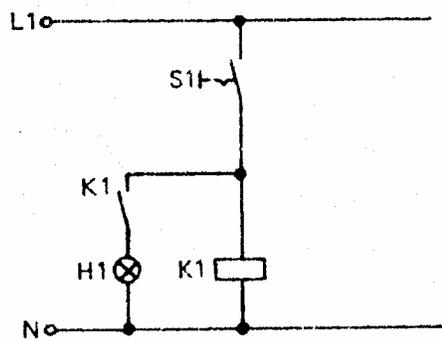
۱- در موقع استفاده از کلید دائم کار باید به منظور روشن کردن لامپ در مسیر آن از یک کستتاکت کمکی مطابق شکل استفاده شود.
