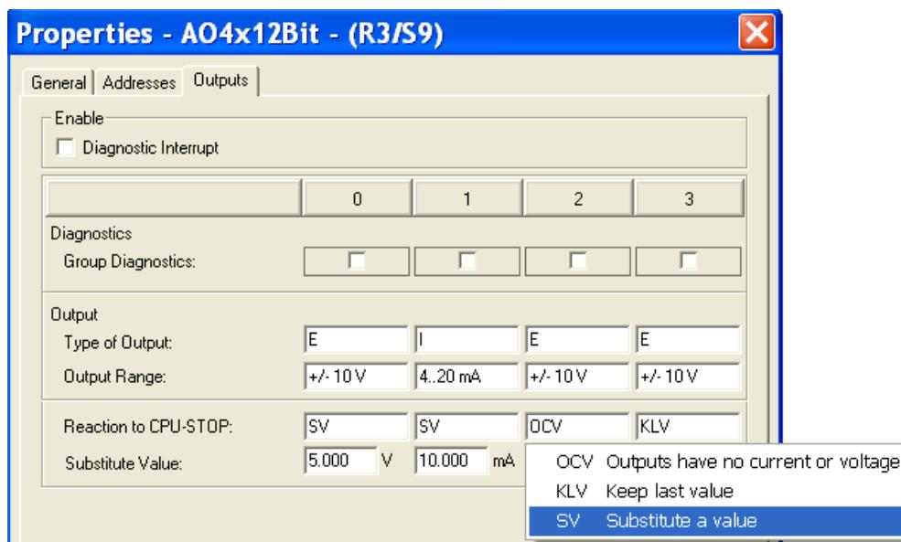
از ویژگی‌های خاص این کارت Diagnostic Interrupt است که اگر فعال شود و سپس Group Diagnostics برای کانال مورد نظر علامت بخورد در مواردی مانند اتصال زمین (برای خروجی‌های ولتاژ) و اتصال کوتاه (برای خروجی‌های جریان) و عدم وجود تغذیه وقفه اعمال می‌کند.
