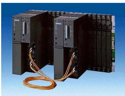
به این سیستم Redundant نیز گفته میشود و در آن دو عدد CPU بعنوان رزرو گرم یکدیگر (Hot-Standby) قرار میگیرند. در صورت بروز خطا روی یکی از CPUها یا مدلولهای مربوط به آن، سیستم بطور اتوماتیک در زمان بسیار کوتاهی به CPU دیگر سوئیچ میشود. در طول مدت سوئیچ شدن خروجیها ثابت میمانند تا مشکلی در فرآیند پیش نیاید. پس از عملیات سوئیچ میتوان مدول معیوب را تعویض یا رفع عیب کرد. برای برنامه ریزی و پیکر بندی این سیستم علاوه بر Step7 باید پکیج H-System نیز نصب گردد.
