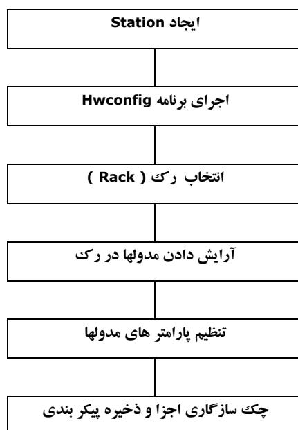
برای فهم بهتر مطلب ، ابتدا به محیط Hwconfig نگاهی می اندازیم سپس یک 300 Station را پیکربندی کرده تا خواننده با برخی جزئیات آشنا گردد پس از آن به سراغ پیکربندی 400 Station میرویم و تفاوت های آن با نوع 300 و نکات خاص مربوط به آن را توضیح میدهیم.
