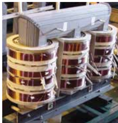
شکل (۱۳-۳) الف - هسته و سیم پیچ‌های ترانسفورماتور سه فاز
