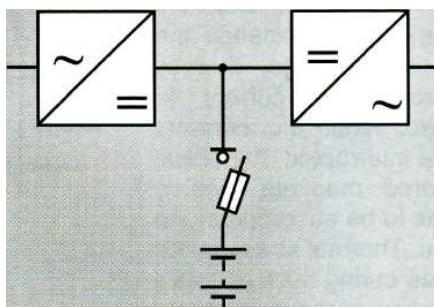
شکل ۱۰،۱۳- مدار کلید زنی یک سیستم UPS
