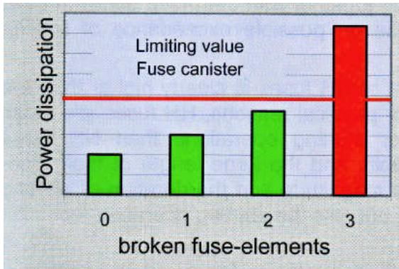
شکل ۱۱.۴ - اثرات دمایی المانهای فیوزی ذوب شده
