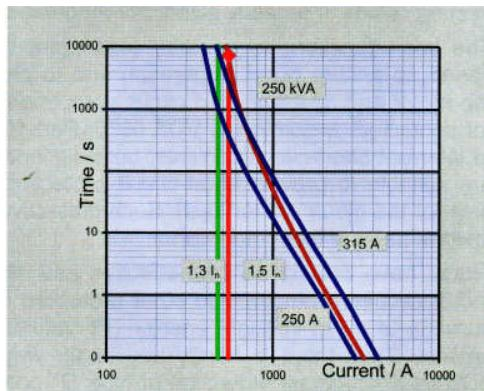
شکل ۱.۱۰- محافظت بهینه ترانسفورماتور با استفاده از فیوز gTr
