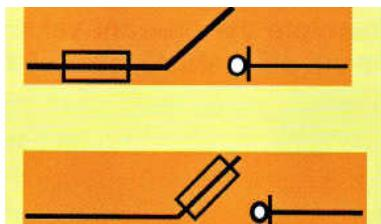
ترکیبیهای فیوزی در فشار ضعیف دارای طبقه بندیهای متفاوت متناسب با نوع کارکرد
