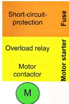
شکل ۲-۱۰.۲- دیاگرام مدار موتور
