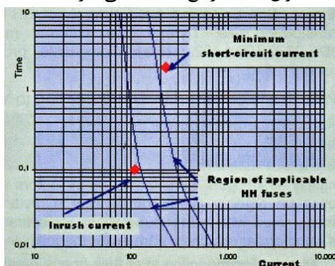
شکل ۱۱.۲ - حفاظت ترانسفورماتور مطابق با استاندارد VDE 0670 Part 4 مشخصات "Time-Current" فیوزهای HH باید بالاتر از این نقطه باشد تا بتواند مانع از قطع المانهای منفرد فیوز در برابر جریان هجومی شود. بدون اینکه هیچ فیوز اصلی در
