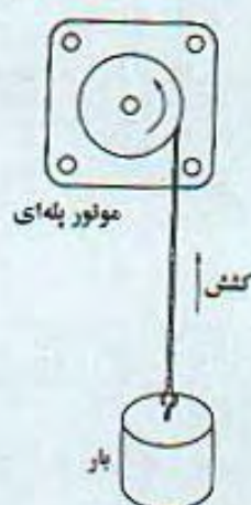
شکل ۶.۱۲. گشتاور ترمزکننده ثابت بعلمت نیروی جاذبه.
