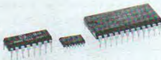
شکل ۵.۷. توالی‌سازهای منطقی MSI. PMM8714، PMM8723، PMM8713
