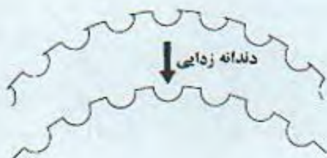
شکل ۹.۱۴. دندانه زدایی لبه دندانه.
