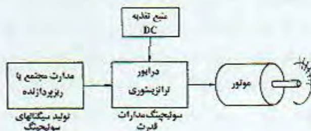
شکل ۱.۲: سیستم درایو مدرن برای یک موتور پله‌ای.
