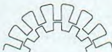
شکل ۳.۱۵. ساختار دندانه‌ای دارای گام‌های دندانه متفاوت در روتور و استاتور.
