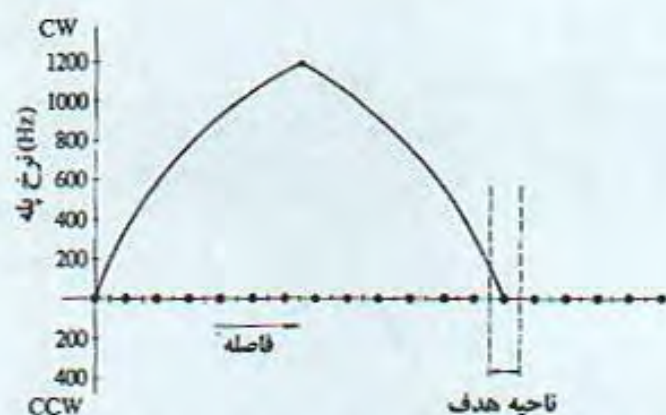
شکل ۷.۲۴. نمودارهای سرعت بر فاصله بهینه برای حرکت ۱۳ - پله‌ای
