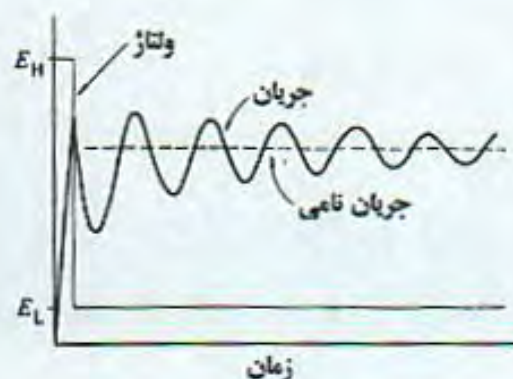
شکل ۵.۲۰. شکل موجهای ولتاژ و جریان در یک درایو دوولتاژ.
