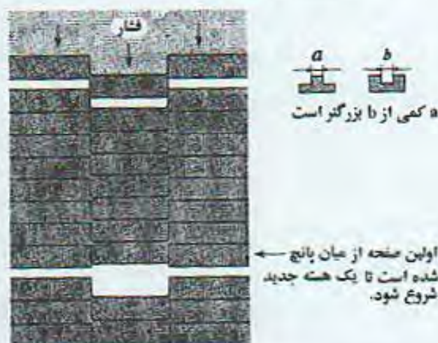
شکل ۹.۸. سرهمبندی خودکار هسته (FASTEC) برای تولید انبوه.
