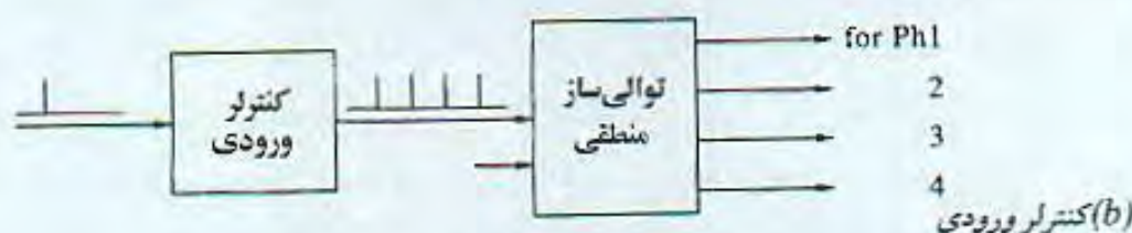
شکل ۵.۱. بلوک دیاگرام سیستم درایو یک موتور پله‌ای.
