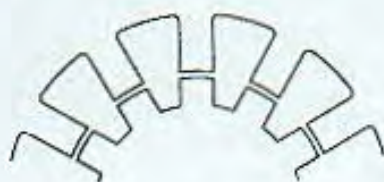
شکل ۳.۱۴. ساختار دندانه‌ای دارای گام دندانه یکسان در روتور و استاتور.
