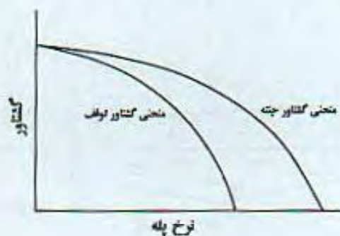
شکل ۶.۱۶. منحنی‌های گشتاور توقف و چنته.
