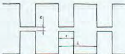
شکل ۳.۸ ساختار دندانه‌ای بکار رفته در یک موتور VR چند پشته‌ای، رسم شده بصورت مدل
