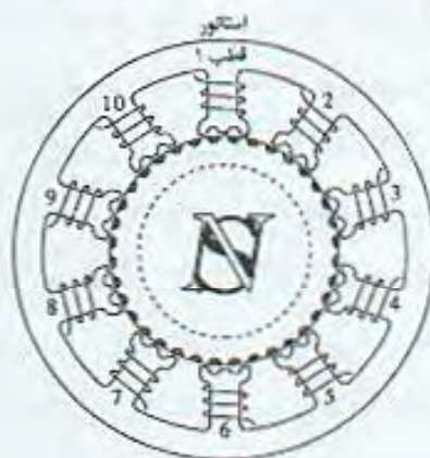
شکل ۲.۳۶. برش عرضی یک موتور هیبرید سه فاز برای درایو یک روتور ۲۰ دندانه‌ای
