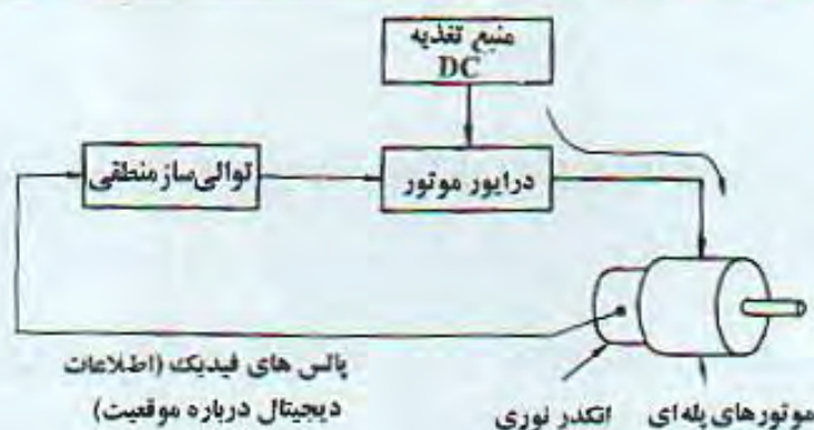
شکل ۷.۱. عملکرد ساده حلقه - بسته یک موتور پله‌ای.
