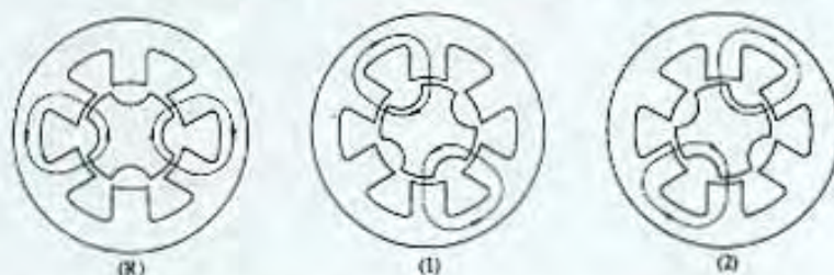
شکل ۲.۵۲. تغییر در الگوی میدان با انجام یک پله در روش دوفاز در تحریک در یک موتور VR سه فاز تک
