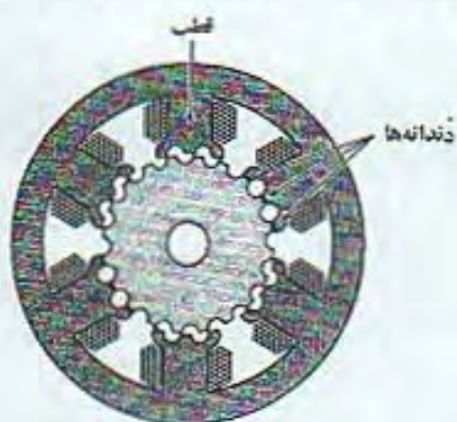
شکل ۲.۱۸. دید مقطع عرضی یک موتور VR سه فاز دارای دو دندانه در هر قطب: تعداد دندانه‌های روتور 20^\circ و زاویه پله 6^\circ می‌باشد.
