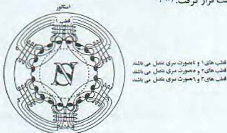
شکل ۲.۳۶. برش عرضی یک موتور هیبرید سه فاز برای درایو یک روتور ۲۰ دندانه‌ای
