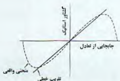
شکل ۴.۴. منحنی گشتاور بر جابهایی و تقریب خطی آن.
