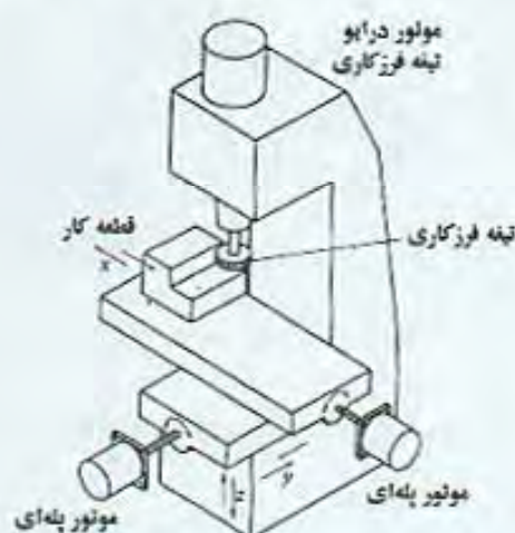
شکل ۸.۱۳ اساس ماشین فرزکاری با کنترل عددی با استفاده از سه موتور پله‌ای.
