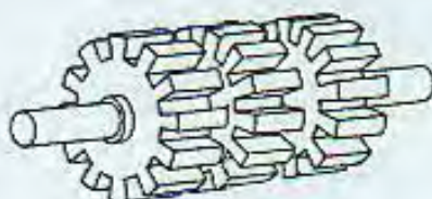
شکل ۱.۶. روتور یک موتور پله‌ای رلوکثانس متغیر چند پشته‌ای.
