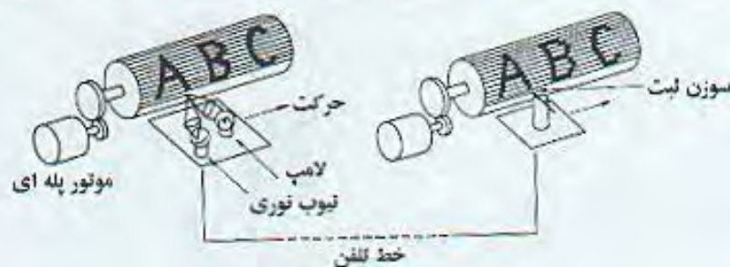
شکل ۸.۱۹. اساس یک ماشین فاکسی مایل.
