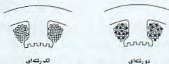
شکل ۲.۴۹. سیم‌پیچی دو رشته‌ای.
