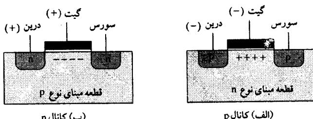
شکل ۱۰-۱۹. ساختار پایه ترانزیستور MOS
