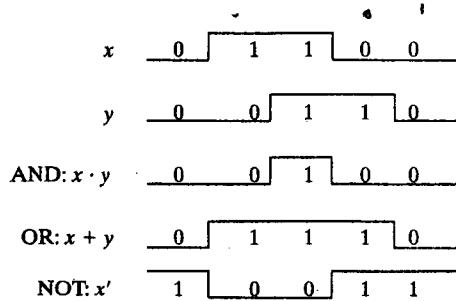
شکل ۱-۵. سیگنال‌های ورودی - خروجی برای گیت‌های (الف)، (ب)، (پ) از شکل ۱-۴
