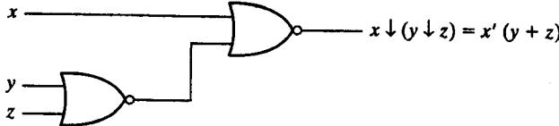
شکل ۲-۶. نمایش شرکت‌نابذیری عملگر NOR (یا NAND) چند ورودی را به عنوان متمم OR (یا AND) آن
