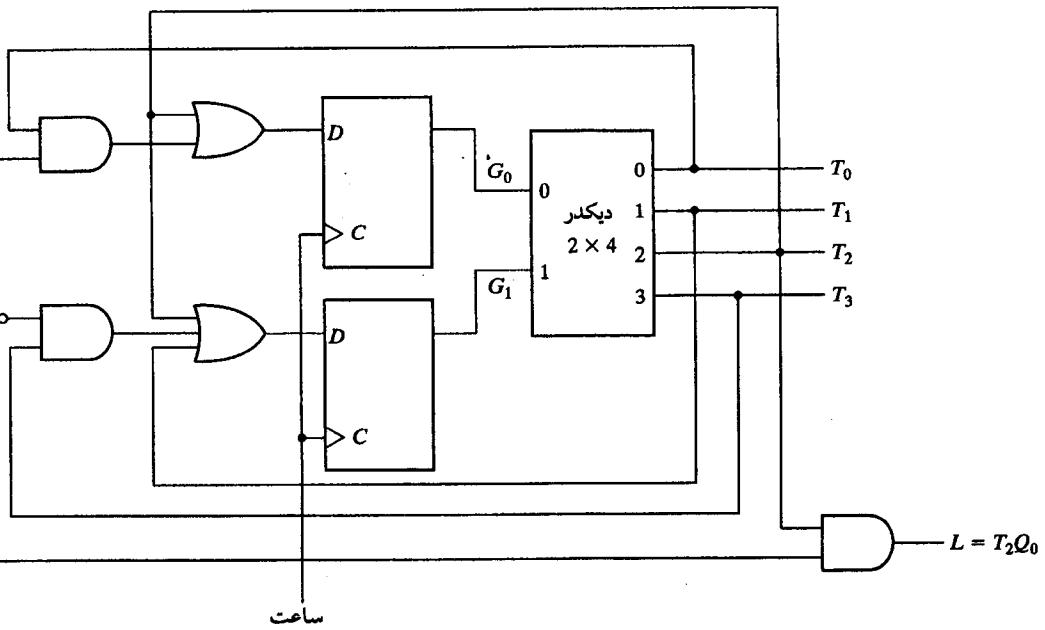
شکل ۸-۱۷. نمودار منطقی کنترل برای ضرب دودویی با استفاده از یک ثبات و دیکدر
