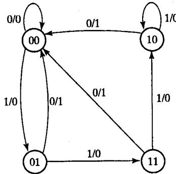
شکل ۵-۱۶. نمودار حالت مدار شکل ۵-۱۵
