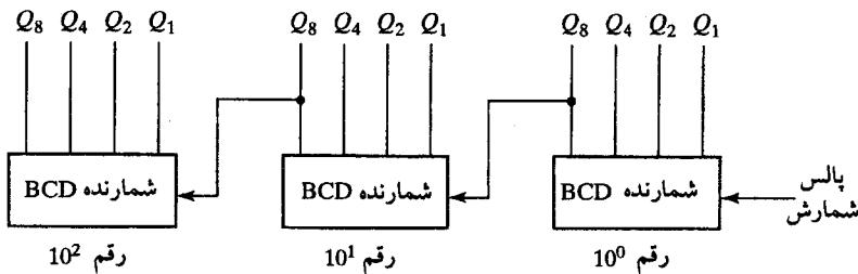
شکل ۶-۱۱. نمودار بلوکی یک شمارنده دهدی BCD با سه دهه
