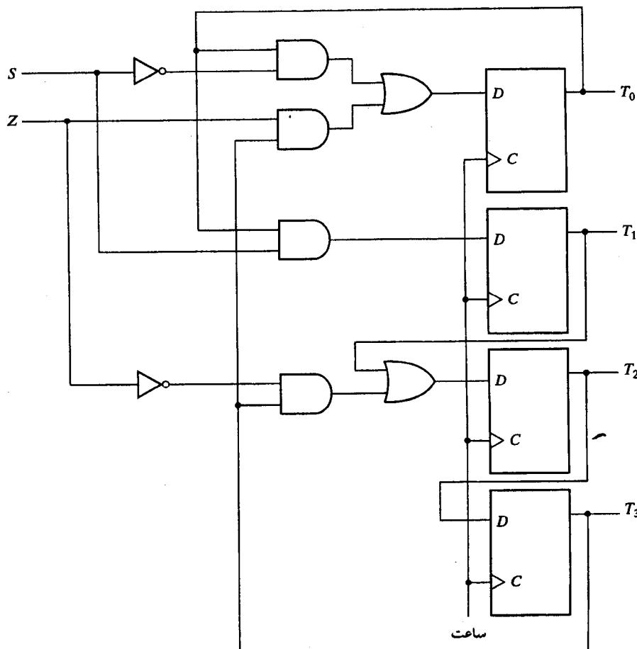
شکل ۸-۱۸. نمودار منطقی کنترل با استفاده از یک فلیپ فلáp در هر مرحله
