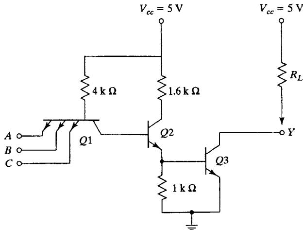
شکل ۱۰-۱۱. گیت TTL کلکتور باز
