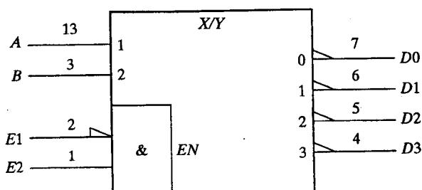
شکل ۱۰-۳. سمبل گرافیکی استاندارد برای یک دیکدر 2 به 4 (نیمسی از آی سی 74155)
