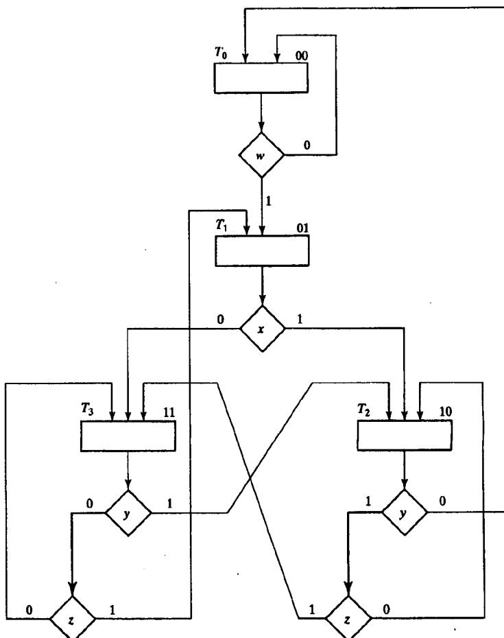
شکل ۸-۱۹. مثالی از چارت ASM با چهار ورودی کنترل
