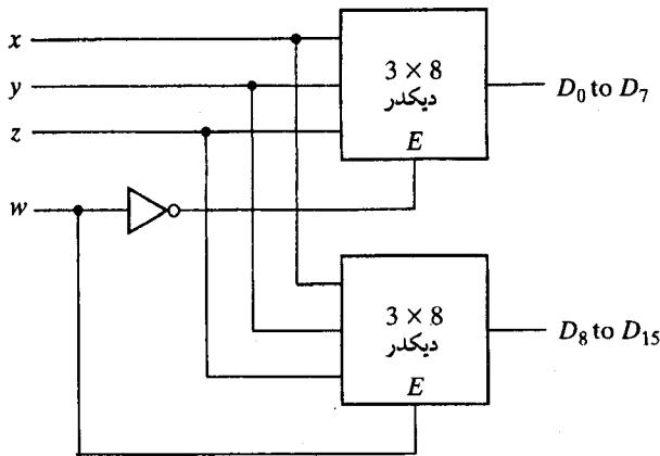
شکل ۴-۲۰. دیکدر  $16 \times 4$  ساخته شده با دو دیکدر  $3 \times 8$
