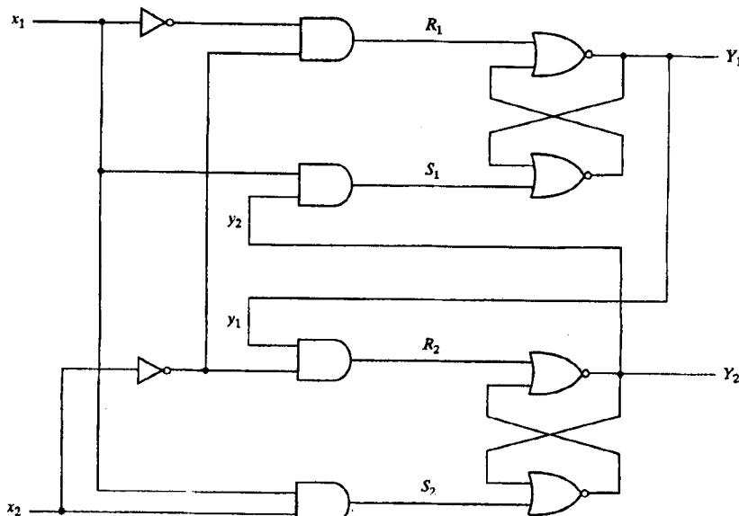
شکل ۹-۱۲. مثالی از یک مدار با لجهای SR
