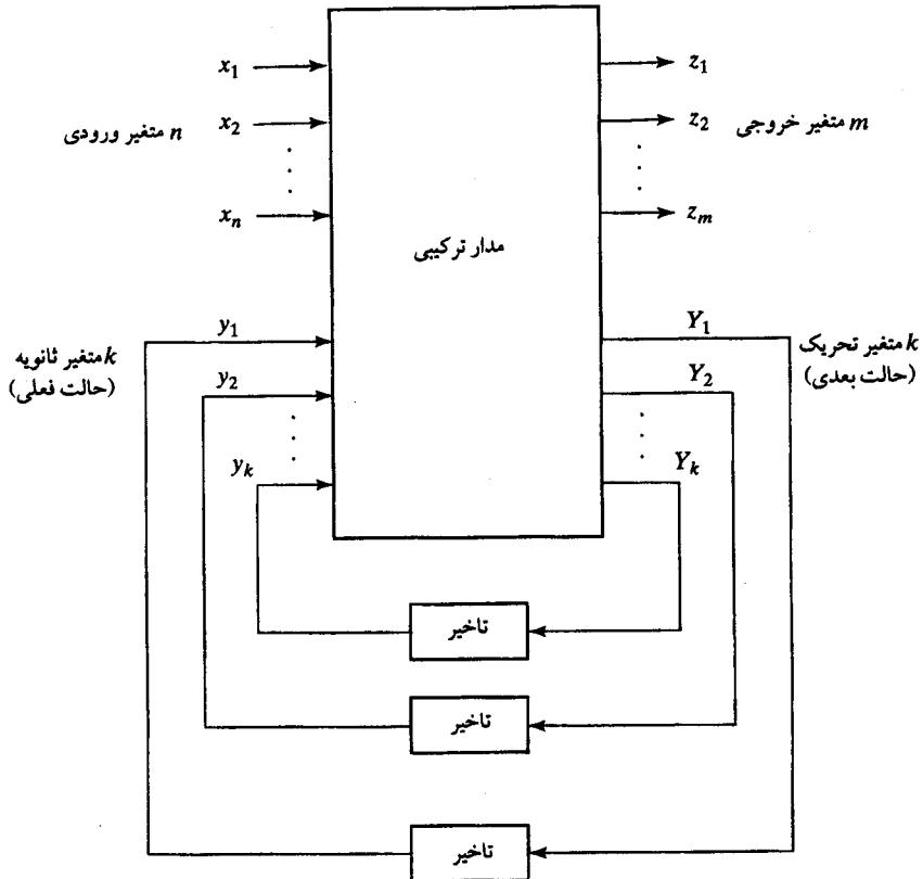
شکل ۱-۹. نمودار بلوکی یک مدار ترتیبی همزمان
