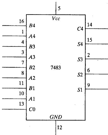
شکل ۱۱-۱۰. آی سی جمع کننده دودویی چهار بیت 7483
