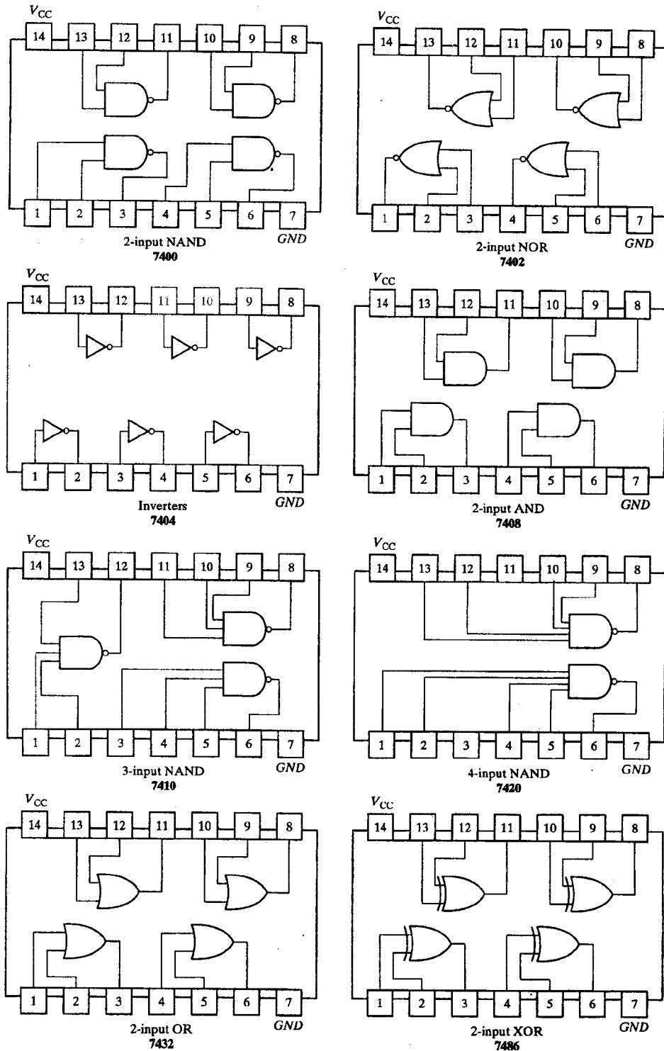
شکل ۱۱-۱. گیت‌های دیجیتال در بسته‌های IC با شماره مشخصه و شماره پایه‌ها
