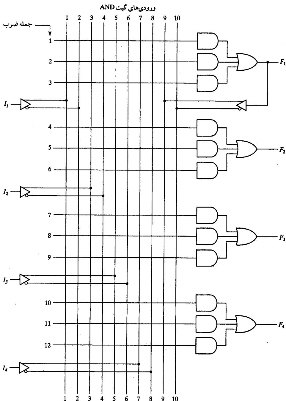
شکل ۷-۱۶. PAL با چهار ورودی، چهار خروجی AND-OR سه رده‌ی فی
