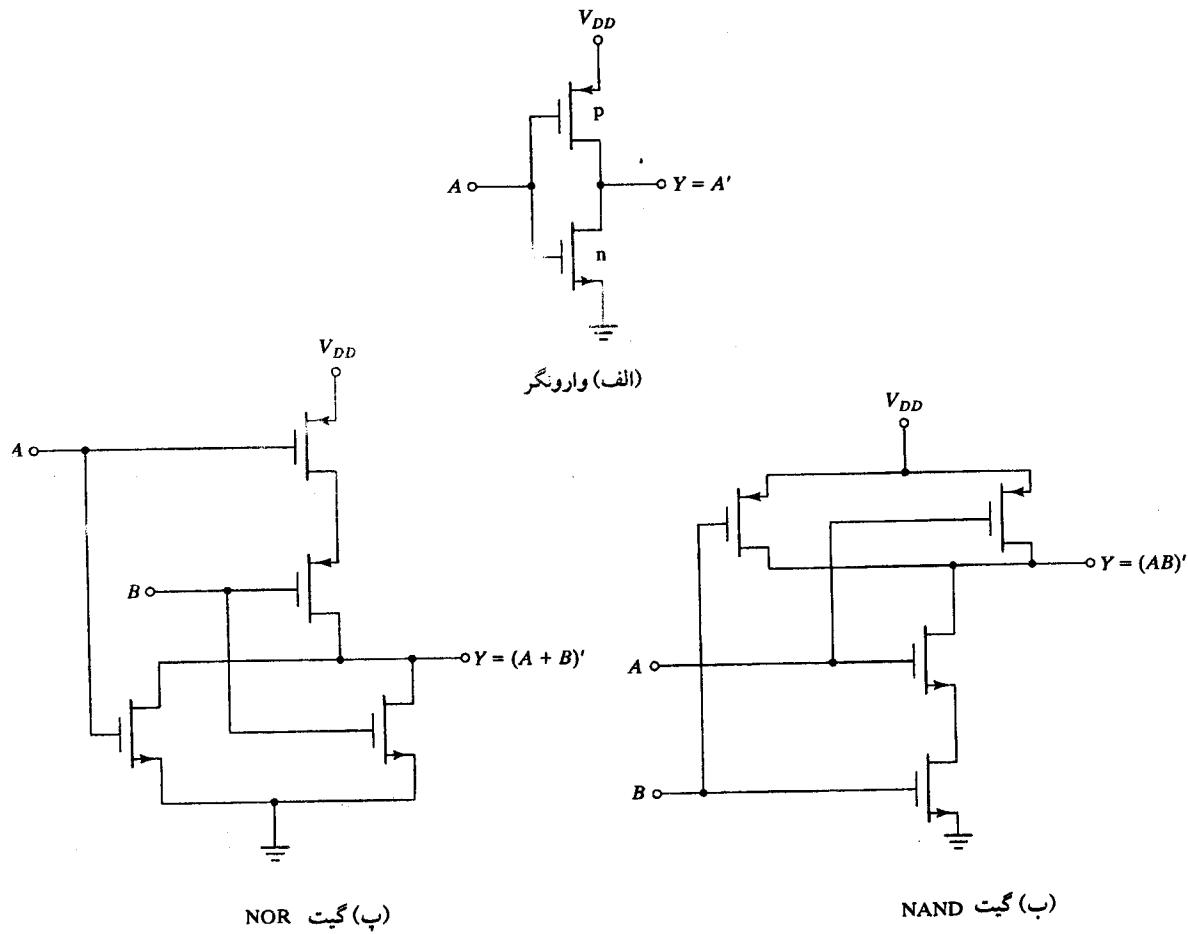
شکل ۱۰-۲۲. مدارهای منطقی CMOS
