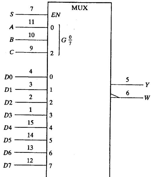
(الف) آی سی 74151 ۸ × ۱ MUX
