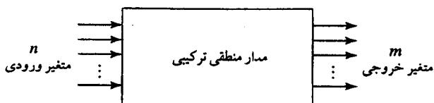
شکل ۱-۴. نمودار بلوکی یک مدار ترکیبی
