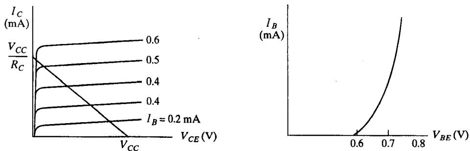
شکل ۱۰-۶. ترانزیستور  $n-p-n$  سیلیکان
