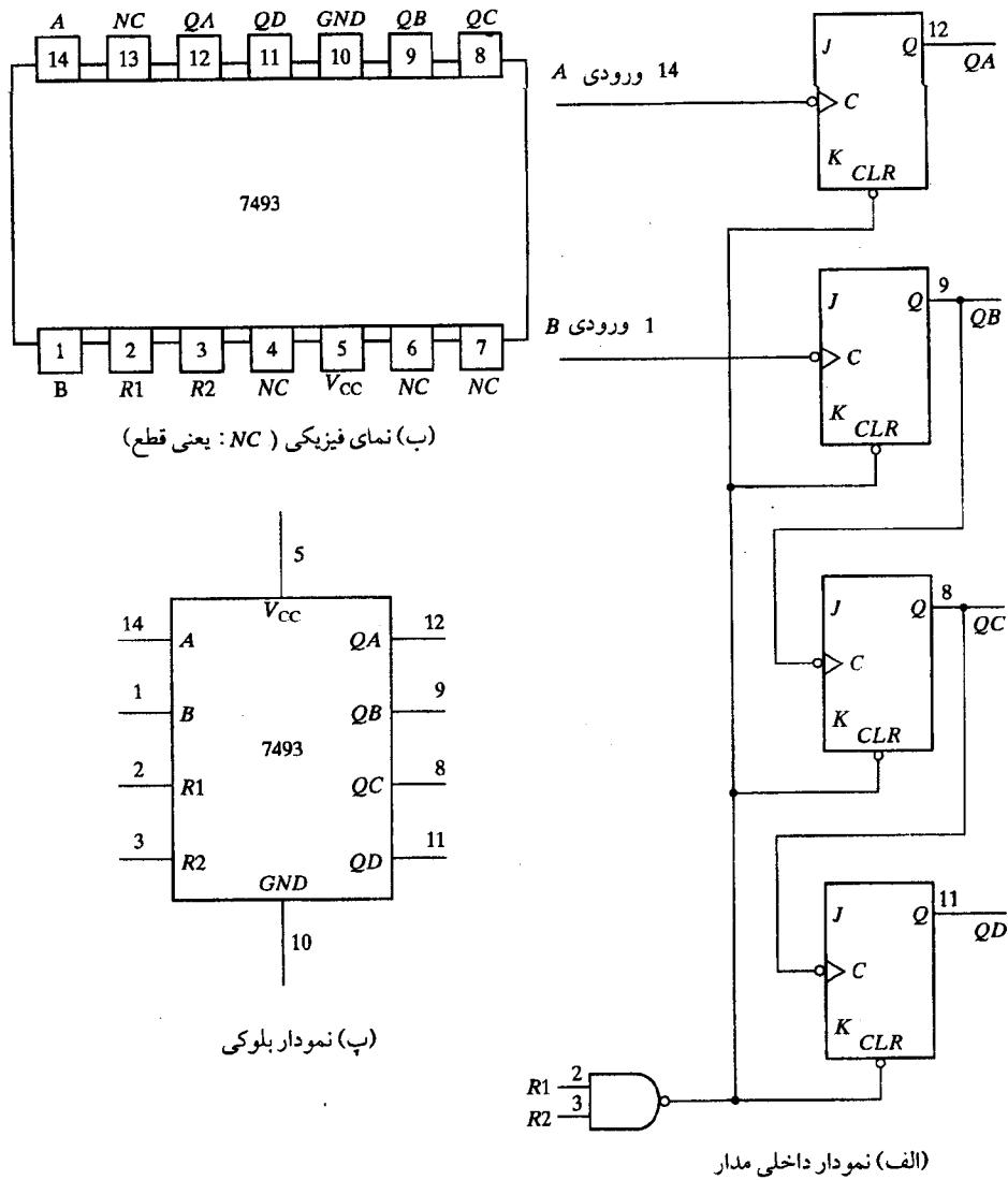
شکل ۱۱-۲. آی سی شمارنده موج‌گونه 7493
