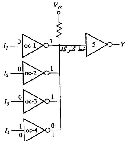
شکل ۱۰-۱۳. گیت‌های کلکتور باز تشکیل دهنده یک گذرگاه مشترک
