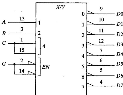
شکل ۱۲-۶. آی سی 74155 بعنوان یک دیکدر  $3 \times 8$
