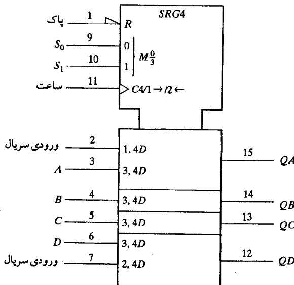
شکل ۱۲-۱۲. سمبول گرافیکی برای یک شیفت رجیستر دو طرفه با بارشدن موازی، آی سی 74194
