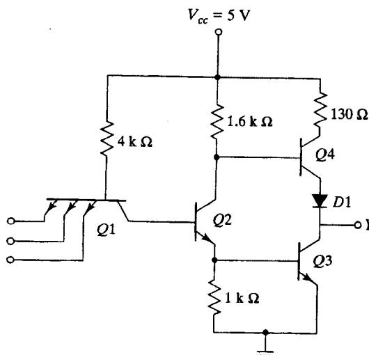
شکل ۱۰-۱۴. گیت TTL با خروجی تاتم پل
