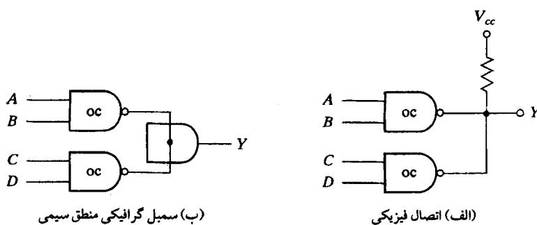
شکل ۱۰-۱۲ AND سیمی دو گیت کلکتور باز'
