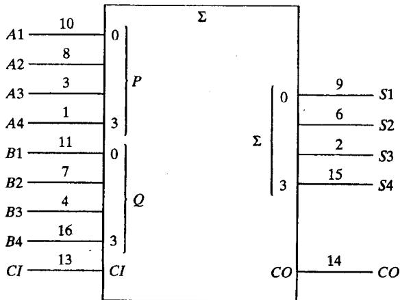
شکل ۱۲-۲. سمبل گرافیکی استاندارد برای جمع کننده موازی چهار بیتی؛ آی‌سی 7483
