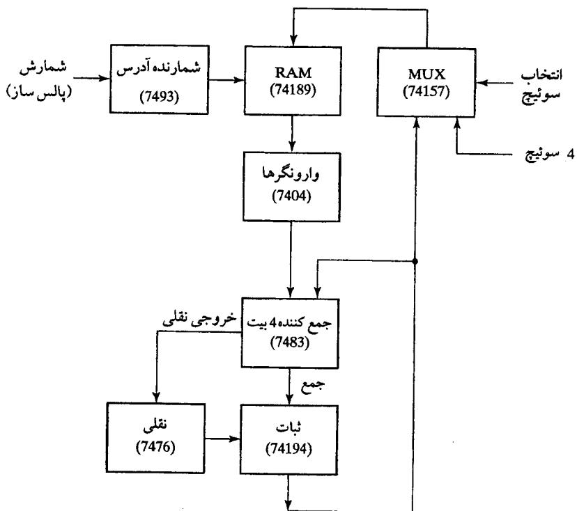
شکل ۱۱-۲۳ . نمودار بلوکی جمع کننده موازی برای آزمایش ۱۶
