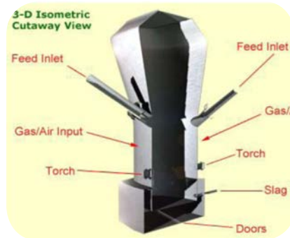
شکل (۳۳) شماتیک راکتور گازساز پلاسما
