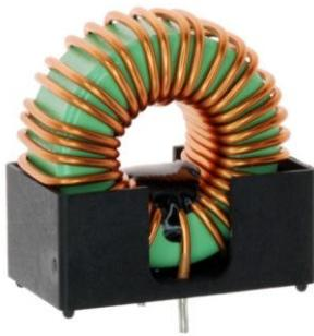
ترانسفورماتورهای حلقوی دونات شکل، برای ذخیره فضا در مقایسه با هسته‌های  $EI$ ، و بعضی اوقات برای کاهش میدان مغناطیسی مورد استفاده قرار می‌گیرند. اینها از یک هسته حلقوی شکل استفاده می‌کنند، سیم پیچی‌های مسی در اطراف این حلقه‌ها پیچیده می‌شوند. (و بنابراین در طی سیم پیچی دور حلقه زه کشی می‌شوند).
