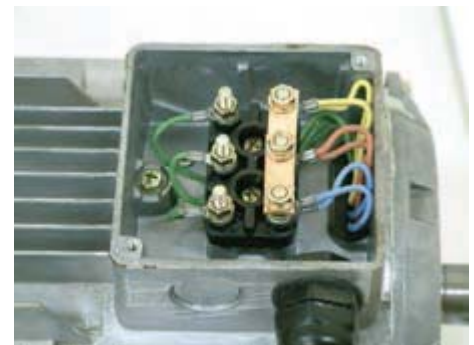
- اتصال ستاره سیم پیچ های موتور
