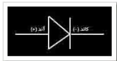
مقدار ولتاژی که باعث می شود دیود شروع به هدایت جریان الکتریکی کند ولتاژ آستانه یا گفته می شود که چیزی در حدود ۰,۶ تا ۰,۷ ولت می باشد اما هنگامی که به دیود ولتاژ معکوس (مثبت به کاتد و منفی به آند) داده می شود جریانی از دیود عبور نخواهد کرد به جز جریان نشستی که مقدار بسیار کمی می باشد و از آن در مدارهای الکتریکی صرف نظر می کنند. دقت کنید که هر دیود یک مقدار آستانه برای حداکثر ولتاژ معکوس دارد که اگر ولتاژ بیشتر از آن شد دیود می سوزد که به آن ولتاژ آستانه شکست دیود گفته می شود.
