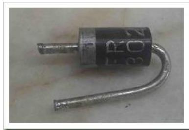
سلکتور مولتی متر را روی دیود قرار داده و پراب قرمز را به سر آند وصل کرده و پراب مشکی را به سر کاتد (با نوار سفید روی دیود مشخص شده است) وصل کنید در این حالت مولتی متر مقداری را نشان می دهد.
