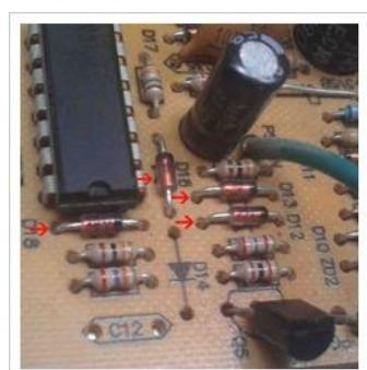
چون دیود زنر باید بصورت معکوس بایاس شود کاتد آن به قطب مثبت منبع ولتاژ و آند آن به قطب منفی منبع ولتاژ وصل می شود، در این صورت جهت جریان از کاتد به آند خواهد بود.
