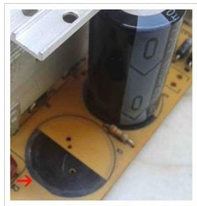
دقت کنید که پلاریته منفی روی بورد با یک نیم دایره سیاه مشخص می شود. برای نصب خازن پلاریته منفی مشخص شده روی بدنه خازن الکتروولیتی را با پلاریته منفی مشخص شده روی بورد تطبیق دهید سپس خازن را روی بورد لحیم کنید.
