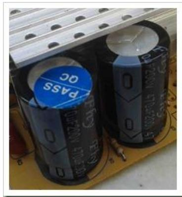
خازن الکترولیتی دارای پلاریته مثبت و منفی می باشد. دقต کنید که برای اتصال خازن روی بورد قبل از لحیم کاری سری از خازن که پلاریته منفی دارد در جای درست خود قرار بگیرد.
