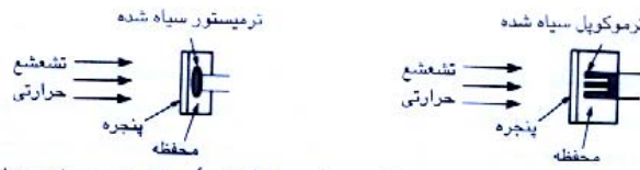
شکل ۴-۱۶ بولومتر از یک سنسور دما تشکیل شده که سطح آن کاملاً سیاه است و در یک محفظه محصور می‌باشد (محفظه ترجیحاً خلأ). تشعشع حرارتی از پنجره عبور کرده و سنسور را گرم می‌کند. سنسور می‌تواند یک ترمیستور و یا یک ترموکوپل باشد.
