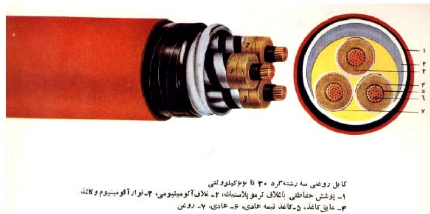
کابل روغنی سه رشته فشاری ۵۰ تا ۶۰ کیلوولتی ۱- پوشش حفاظتی باغلاف ترموپلاستیک، ۲- پوشش فولادی، ۳- نوار فیزی، ۴- غلاف سربی، ۵- نوار آلومینیومی و کاغذ، ۶- نوار کاغذی، ۷- کاغذ نیمه‌هادی، ۸- حادی، ۹- روغن
