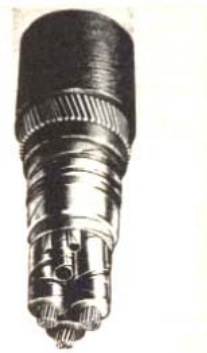
کابل ۴۰ کیلوولتی روغنی با لوله‌های ویژه روغن که در فضای خالی زیر عایق کابل تعبیه شده است.
