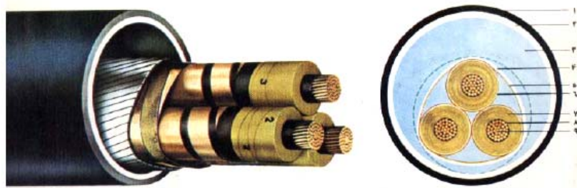
کابل ۱۱۰ کیلوولتی تحت فشار ساز ۱- پوشش خارجی از پلی اتیلن، ۲- فولسه فولادی، ۳- گاز ازت، ۴- غلاف فولادی، ۵- نوار مسی، ۶- نوار مسی و کاغذ نیمه هادی، ۷- کاغذ عایق، ۸- کاغذ نیمه هادی، ۹- هادی مسی یا آلومینیومی.
