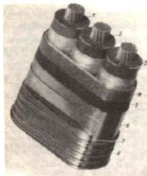
کابل ۶۶ کیلوولتی بین بانوار برنزی خارجی ۱ تا ۳ نوار کاغذی، ۴- پوشش سربی، ۵- پوشش هادی شده، ۶- نوار برنزی، ۷- نوار برنزی اکوردلونی، ۸- سیمهای برنزی برای باندریج کابل
