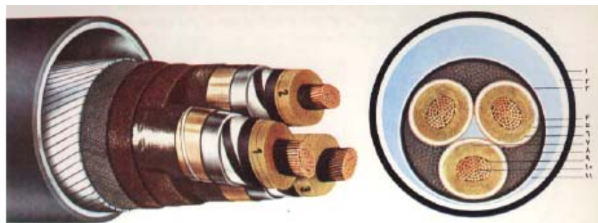
کابل ۱۱۰ کیلوولتی گازی تحت فشار خارجی ۱- پوشش خارجی از پلی اتیلن، ۲- فولسه فولادی، ۳- غلاف فولادی، ۴- نوار مسی و غلاف نازک عایقی، ۵- غلاف سربی، ۶- نوار آلومینیومی، ۷- عایق کاغذی، ۸- عایق پرکننده فضای خالی، ۹- کاغذ نیمه هادی، ۱۰- هادی، ۱۱- گاز ازت.
