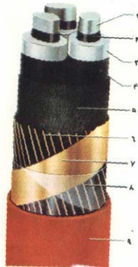
ساختمان کابل ۳۰ و ۳۰ کیلوولت گراس لینک پلی اتیلن ۱- هادی، ۲- نیمه هادی داخلی، ۳- عایق گراس لینک پلی اتیلن، ۴- نیمه هادی خارجی، ۵- نوار فرفری، ۶- زره مسی، ۷- نوار، ۸- غلاف خارجی از پی وی سی
