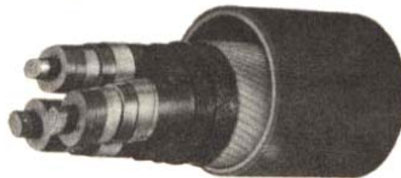
کابل ۶۶ کیلوولتی بین بانوار برنزی خارجی ۱ تا ۳ نوار کاغذی، ۴- پوشش سربی، ۵- پوشش هادی شده، ۶- نوار برنزی، ۷- نوار برنزی اکوردلونی، ۸- سیمهای برنزی برای باندریج کابل
