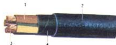
کابل چهار رشته مسی افشان با پوشش داخلی و خارجی از مواد ترموپلاستیک ۱- عایق ترموپلاستیک، ۲- پوشش مشترک PVC، ۳- هادی مسی، ۴- باند مشترک
