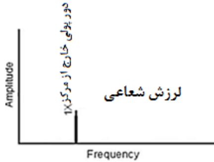
شکل ۹-۲۲ طیف حاصل از پولی خارج از مرکز
