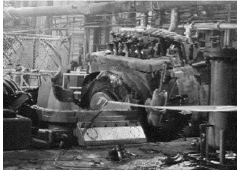
شکل ۳-۱۶ توربین آسیب دیده از سرعت بیش از حد
