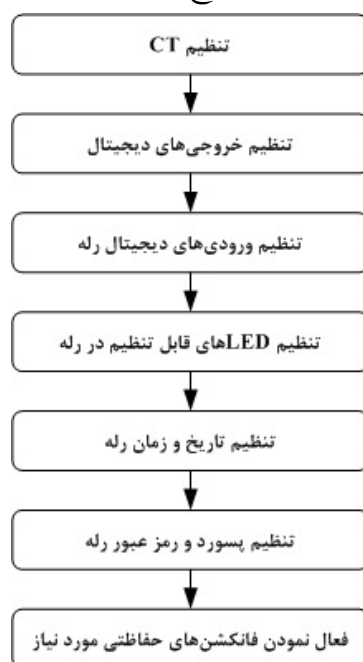
شکل 8-1: روندنمای تنظیمات اولیه رله ثانویه
