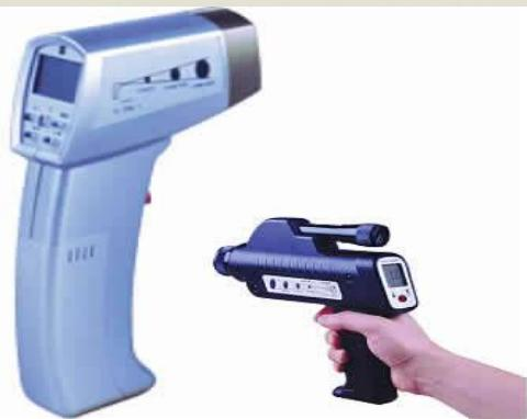
برای اندازه گیری دما از شیوه های گوناگونی استفاده میشود در روش های معمول شما نیاز به تماس مستقیم سنسور دمائی با سطح یا مورد نظر داشته اید ولی در روش اندازه گیری دما به صورت غیر تماسی در حقیقت از تشعشعاتی که از یک جسم داغ پراکنده میشود که معمولا در ناحیه مادن قرمز میباشد استفاده کرده و با مکانیزم های مختلف این تشعشعات را اندازه گیری کرده و بر حسب دما کالیبره میکنند.
