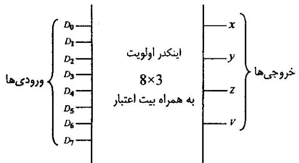
در جدول فوق اولویت ورودی‌ها بیشتر است و به طور کلی ترتیب اولویت‌ها به صورت  $D_0 < D_1 < D_2 < D_3 < D_4 < D_5 < D_6 < D_7$  می‌باشد بنابراین مثلاً در خط آخر که  $D_7 = 1$  است مقدار بقیه ورودی‌ها اهمیت نداشته و خروجی برابر  $x = y = z = 111$  خواهد بود. بیت  $v$  (بیت اعتبار) هنگامی که هیچ یک از ورودی‌ها فعال نباشد (هیچگدام از  $D$ ‌ها برابر 1 نباشد) برابر 0 خواهد بود و لذا در لحظه‌ای که  $v = 0$  است مقدار خروجی‌ها  $(x, y, z)$  نا معتبر بوده و نباید استفاده شوند.
