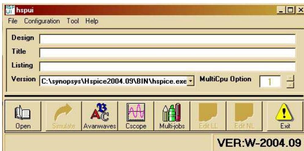
نرم افزار Hspice جهت تحلیل مدارها تنها به یک نوع فایل با پسوند .sp نیاز دارد . این فایل ، متن برنامه ایست که مدار را به شکل قابل فهم برای نرم افزار تفسیر می کند . اطلاعات متفاوتی شامل شکل مدار ، نوع تجزیه و تحلیل مورد نیاز ، ورودی ها و خروجی ها ، همه با هم در این فایل قرار دارند و هر مدار تنها در یک فایل با پسوند .sp و نام متفاوت قرار دارد .
