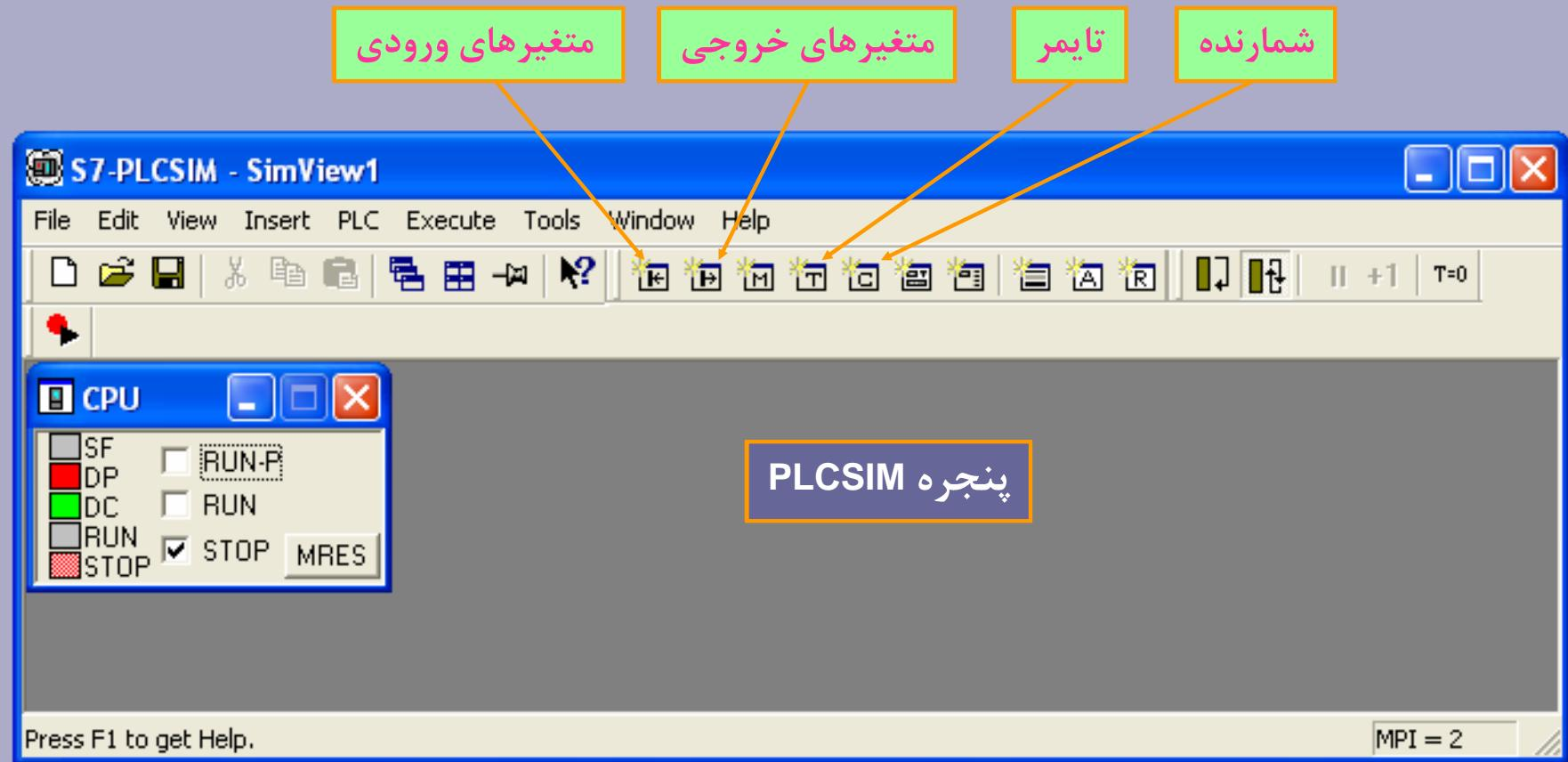
یکبار روی "متغیر ورودی" و بار دیگر روی "متغیر خروجی" کلیک می کنیم تا مطابق شکل صفحه بعد، پنجره تنظیم هر کدام ظاهر شود.
