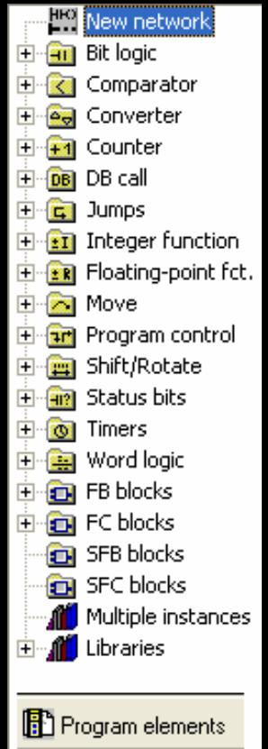
کلیه اجزاء تشکیل دهنده یک سیستم اتوماسیون اعم از کلیدها و کن tact ها، تایмерها، شمارنده ها و ... را المان های برنامه می گویند. در این بخش تمامی المان های مربوط به نوع **S7 300** با ذکر مثال و نحوه کار توضیح داده خواهد شد.
