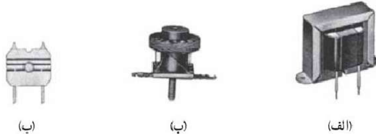
الف - چوک بلندگو، ب - چوک فرکانس بالای بدون پوشش، پ - چوک فرکانس بالای با پوشش
