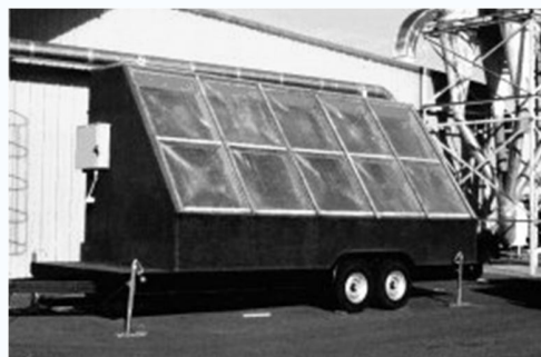
یک خشک کن خورشیدی که برای خشک کردن چوب به کار می رود
