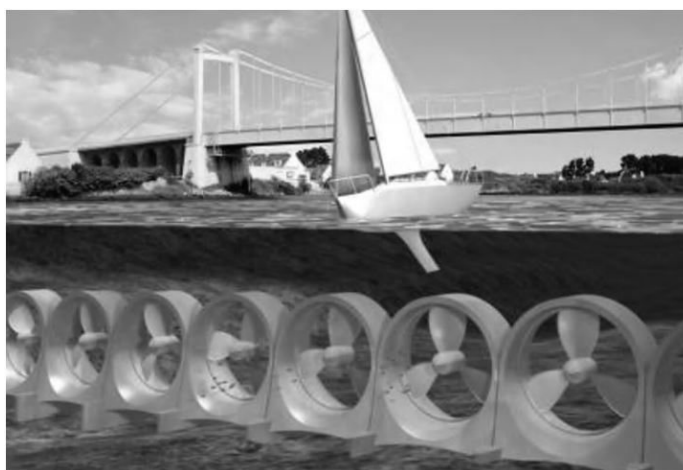
شکل ۱۰-۱ شماتیکی از اولین طرح توربین جریان جزر و مدی: روتور بر روی تیغه‌های مکانیکی نگه داشته می‌شود که در این جا دیده نمی‌شوند، زیرا درون داکت‌ها قرار گرفته‌اند (© Sabella SAS)
