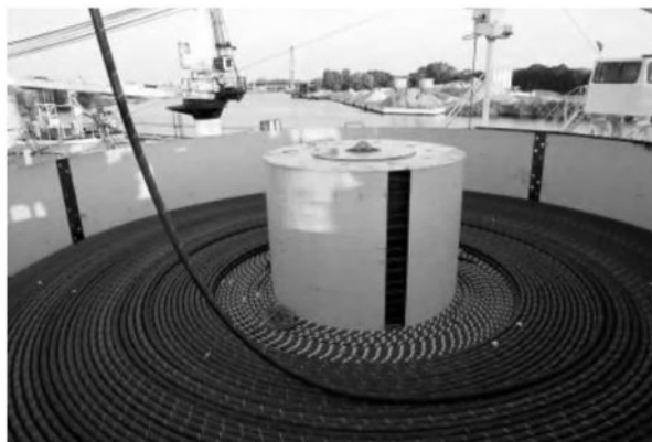
شکل ۵-۱۴ بارگذاری کابل مخصوص زیر دریا در کشتی حامل کابل برای مزرعه‌ی بادی فراساحلی (© DOTI GmbH)
