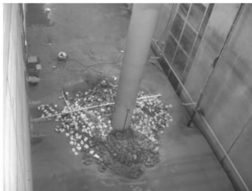
شکل ۴-۵ آزمایش‌هایی بر روی سنگ‌ریزه‌ها برای جلوگیری از فرسایش پیرامون یک ستون در حوضچه‌ای با موجی در این کانال به عرض ۵ m (شرایط روبه‌رو شده در دریا دوباره تولید شده‌اند). بستر با ماسه پوشیده شده و بلوک‌ها، سنگ‌ریزه‌های محافظ را شبیه‌سازی می‌کنند. این آزمایش با پر کردن حوضچه با آب و تولید امواج در
