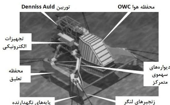
شکل ۱۱-۱۷ سیستم Oceanlinx [PRE 04]
