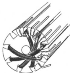
شکل ۱۳-۵: یک آرمیچر حلقوی که تعداد شیارهایش دوبرابر تعداد کلاف آن سیم پیچی شده است.
