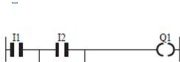
الف - نقشه ی نردبانی مدار راه اندازی موتور دایم کار
