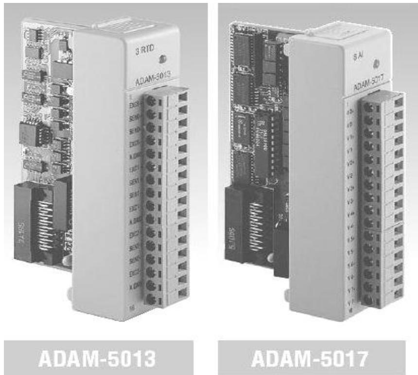
شکل ۵-۶: یک نمونه ماثول RTU
