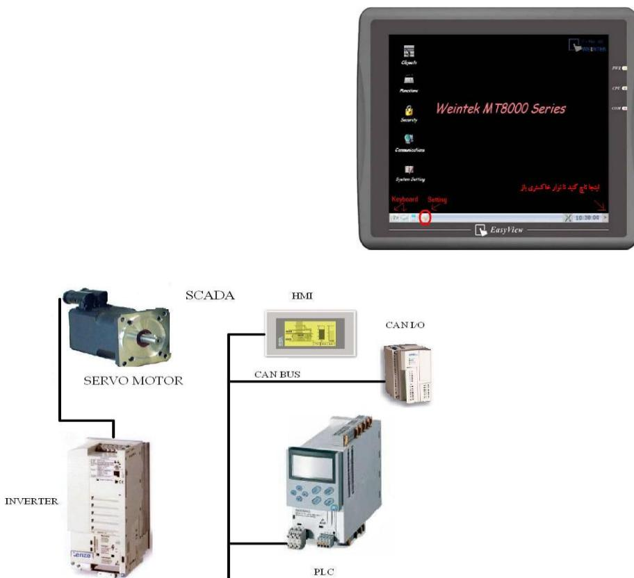
شکل ۳-۵: ارتباط HMI برای کنترل دور موتور
