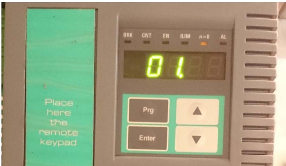
از کلید Prg برای رفع پیغام خطأ و خروج از پارامتر و بازگشت به منوی قبلی استفاده می شود. کلید Enter برای انتخاب پارامتر و یا ورود به منو و تغییر پارامتر بکار می رود. کلیدهای جهت بالا و پایین هم برای افزایش و کاهش مقدار پارامتر و یا حرکت در بین منو ها کاربرد دارد. لامپ های LED بالای کی پد وضعیت کن tactور ترمز و کن tactور اصلی و Enable بودن درایو و حد جریان و سرعت غیر صفر و خطأ روی درایو را نشان می دهند.
