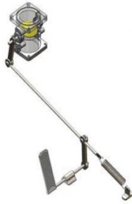
شکل ۳-۱ اصول دریچه گاز مکانیکی [۶]
