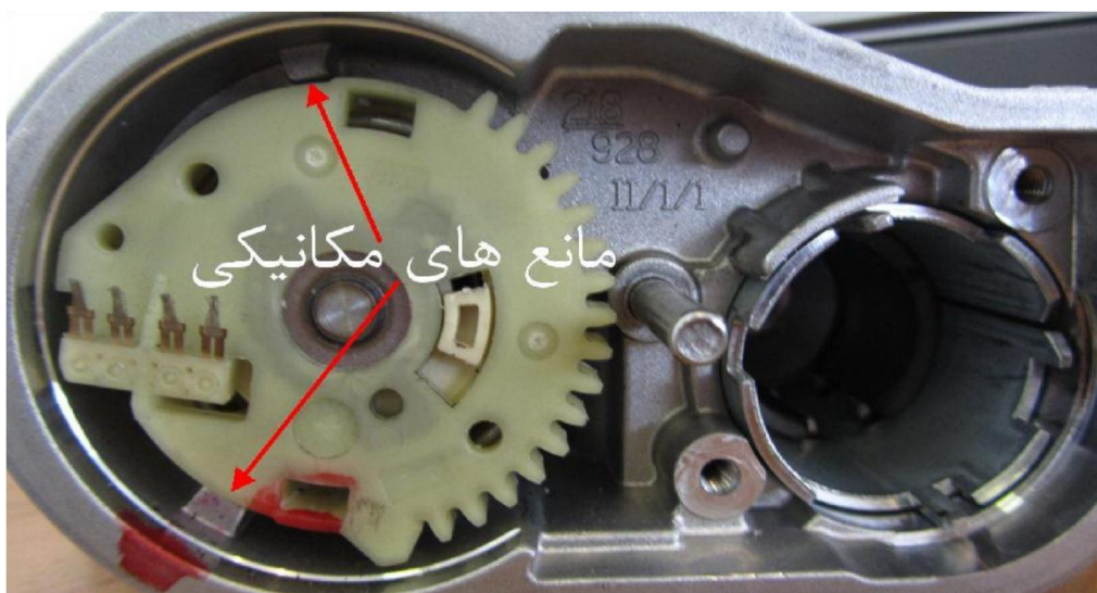
شکل ۲-۲۳ دو مانع مکانیکی در ابتدا و انتهای ناحیه کاری دریچه‌گاز الکترونیکی
