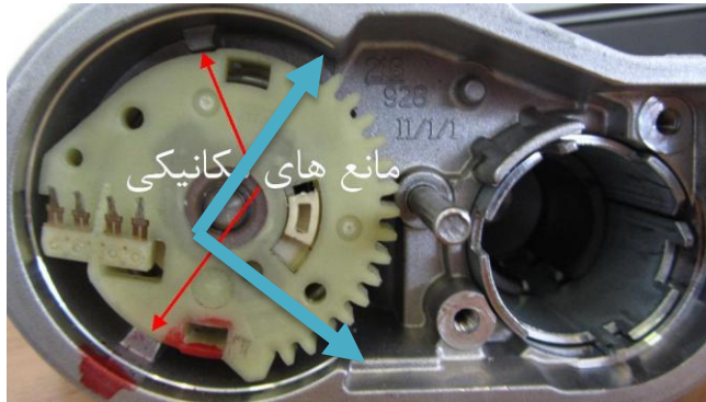
شکل ۱۶-۲ به دست آوردن تعداد دندانه های چرخ دنده چهارم
