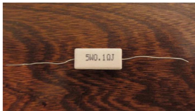
شکل ۲-۲۷ مقاومت آجری مورد استفاده برای به دست آوردن جریان
