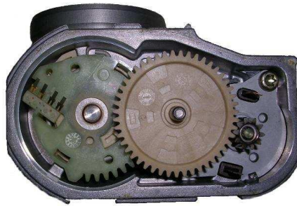
شکل ۲-۱۳ چرخ دنده های دریچه گاز الکترونیکی
