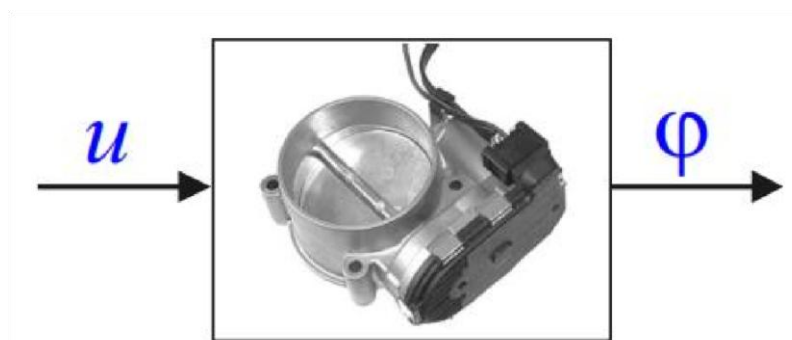
شکل ۴-۲: دریچه گاز از دید ورودی-خروجی
