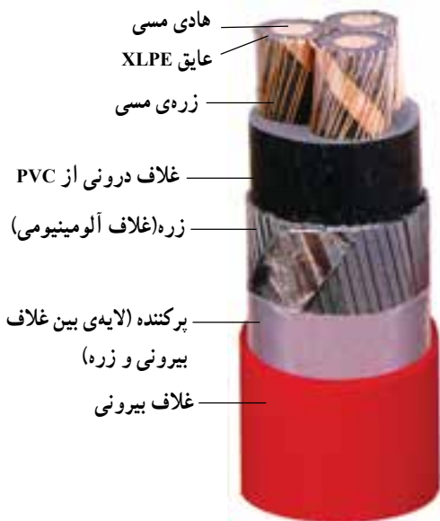
شکل ۴-۳۹- کابل با غلاف آلومینیومی
