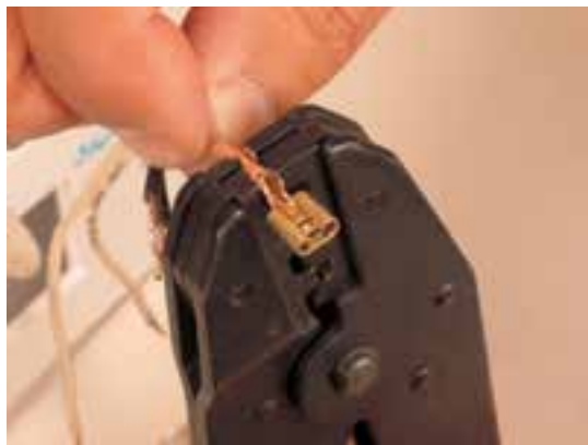
شکل ۲۳-۳- نحوه‌ی پرس کردن سرسیم
