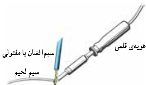
شکل ۴-۲۹- اصول صحیح قلع اندود کردن سرسیم
