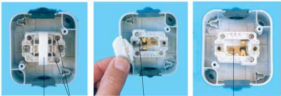
تیغه‌ی پلاتین فتر عمل‌کننده ترمینال‌های ورودی و خروجی اهرم قطع و وصل الکلنگی
