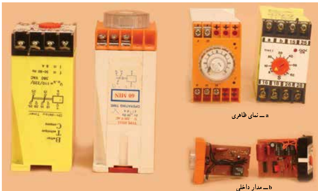
شکل ۸-۲۳- نمای ظاهری و مدار داخلی تایمر الکترونیکی
