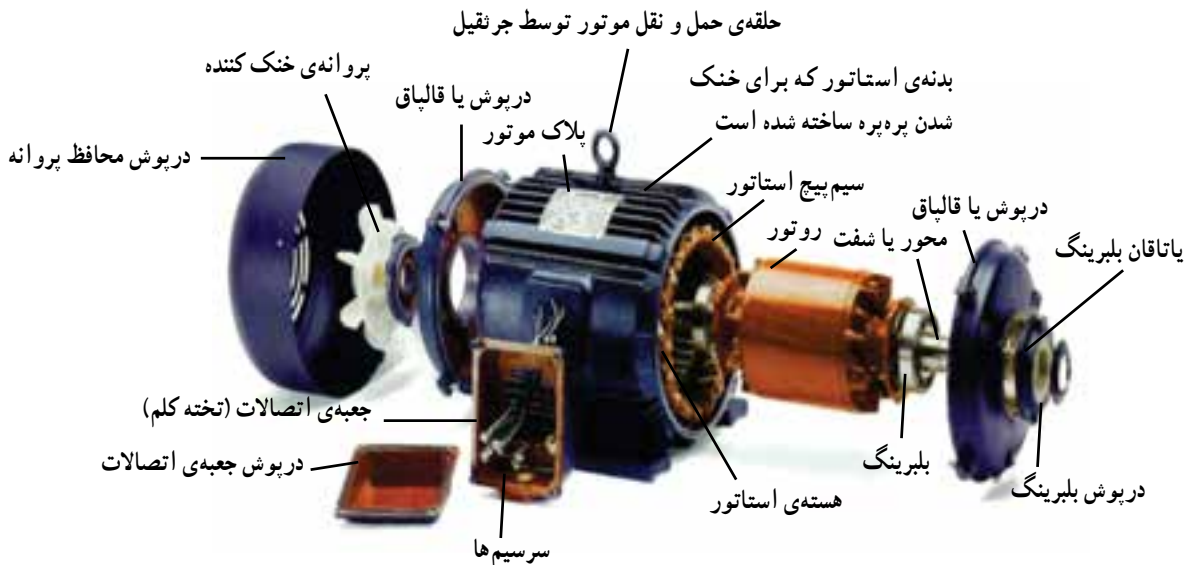
شکل ۱۳-۷- اجزای تشکیل دهنده یک موتور القایی با رتور قفس سنجابی
