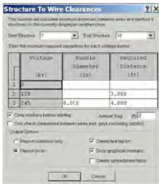
شکل (۸-۲۲)- فاصله سیم ها با استراکچر
