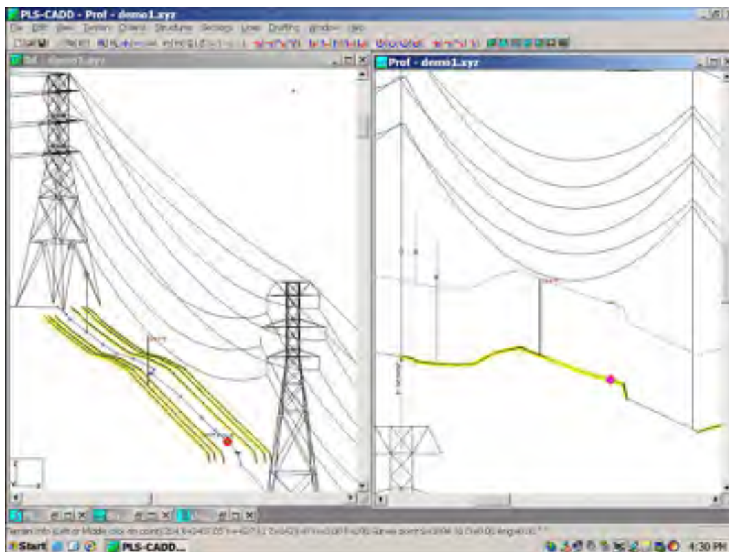
شکل (۸-۳۵) - اتیکت نسبت حرارتی برای اسپن انتخاب شده
