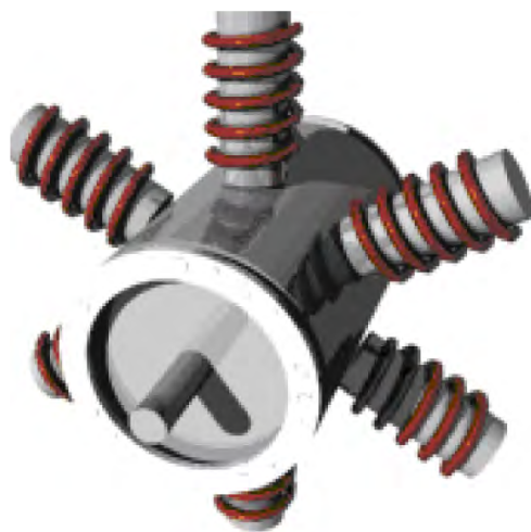
نمونه ای از روتور و استاتور در موتور آسنکرون
