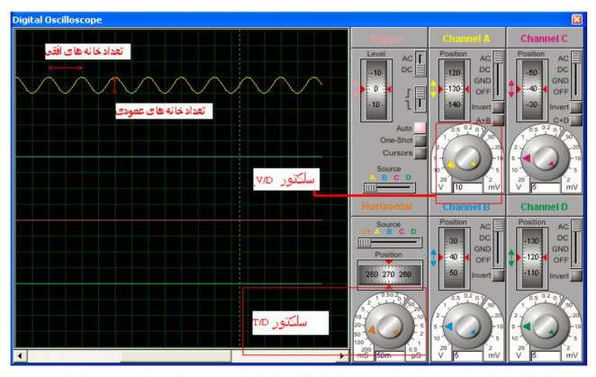
در مثال بالا تعداد خانه های عمودی بر ابر با 1 و تعداد خانه های افقی بر ابر با 2 است همچنین سلکتور T/D روی 50 میلی ثانیه و سلکتور V/D روی 10 ولت قر ار دارد ، بنابر این طبق فرمول های بالا مقدار زمان تناوب 100 میلی ثانیه ، مقدار فرکانس 120 هر تز
