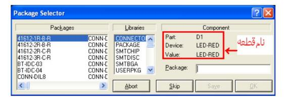
در صورتی که با پیغام زیر روبرو شدید مدل pcb انتخاب شده مناسب قطعه نمیباشد و شما باید یک مدل pcb دیگر را انتخاب کنید (معمولا در پروتوس از هر قطعه چندید نوع وجود دارد ، موارد دیگر را انتخاب کنید):
