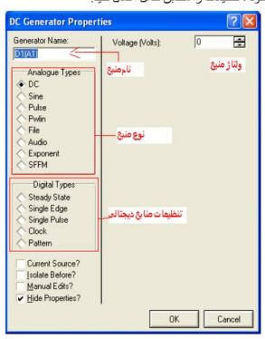
در قسمت "ولتار منبع "، باید ولتار مورد نیاز نوشته شود ، در این مدار با 3 ولت برای راه اندازی led موجود نیاز داریم ، بنابراین در
