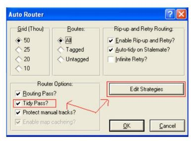
در قسمت Edit Strategies دو نوع تنظیمات وجود دارد ، تنظیمات خطوط vcc) power و گراند ) و تنظیمات خطوط single در قسمت کاملا مشابه هم میباشند ) : عادی ، در زیر تنظیمات مربوط به power را بررسی میکنیم ( هر دو قسمت کاملا مشابه هم میباشند ) :
