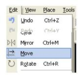
مشاهده میکنید که اشاره گر موس به شکل یک مربع در میاید ، در گوشه ای از فایل cam کلیک کنید و کل فایل را انتخاب نمایید : برای انتخاب فایل در یک گوشه ی ان کلیک کنید و نگه دارید و به سمت گوشه ی دیگر بگشید ، هنگامی که کل فایل در داخل مربع قرار گرفت دوباره کلیک کنید تا کل فایل به شکل زیر در اید :
