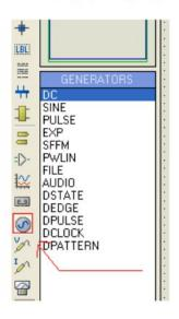
اولین منبع ، منبع ولتاژ dc میباشد ، این منبع میتوانید یک ولتاژ dc را تامین کند ، مدار زیر را در پروتوس رسم کنید :
