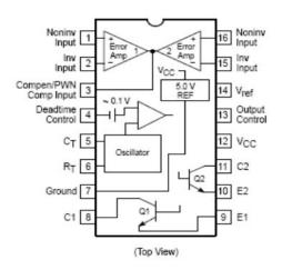
ای ایسی که در منابع تغذیه سویچینگ کاربرد دارد ، تهیه کننده پالس pwm بر ای راه اندازی تر انزیستور های قدرت میباشد دیتا شیت این ایسی را میتوانید از سایت <u>www.datasheet4u.com</u> تهیه کنید .
