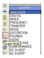
در مکانی مناسب در صفحه شماتیک کلیک کنید و شروع به کشیدن به اندازه دلخواه کنید ، وقتی به اندازه مناسب رسیدید دوباره کلیک کنید تا ابزار در انجا گذاشته شود:
