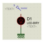
سپس آن را با سیم به مدار متصل کنید (موس را روی نقطعه مورد نظر از مدار ببرید ( مثبت led)، هنگامی که ایکون فلش موس به مداد تبدیل شد ، بر روی نقطه کلیک کنید و مسیر را تا منبع ادامه دهید):
