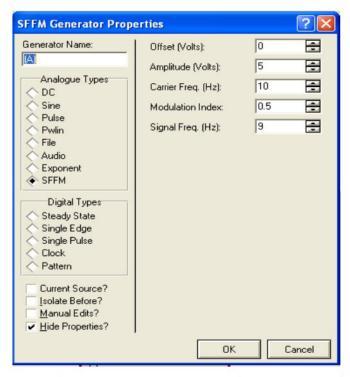
در پنجره بالا offset مقدار سطح dc اضافه شده به ولتاژ است همچنین amplitude دامنه ولتاژ هر دو شکل موج را مشخص میکند. Carrer , single freq نیز فرکانس سیگنال اصلی وسیگنال حامل میباشد و گزینه ی modulation index مشخص کننده ضریب مدولاسیون است . بر ای دیدن شکل موج این منبع از اسیلوسکوپ استفاده کنید .
