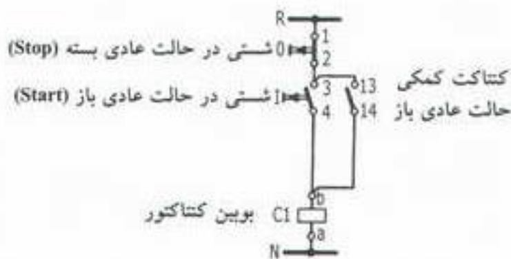
شکل ۱۰-۱- نمونه‌ی ساده‌ی مدار فرمان یک کنتاکتور
