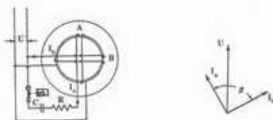
شکل ۶-۶- راه‌اندازی موتور تک‌فاز با استفاده از خازن راه‌انداز
