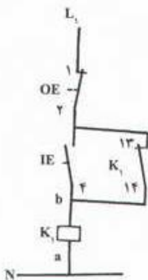
شکل ۱۰-۲- یک مدار فرمان ساده در حال کار
