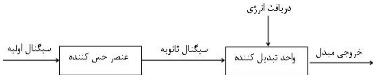
شکل 3 شکل شماتیک یک ترانسدیوسر (مبدل)
