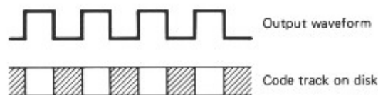
خروجی اینکودر تاکومتر و تک شیار
