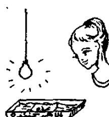
شکل ۱۰۹ - برای فرستادن یک سند به وسیله عکس نگار خط به خط، این سند را که روی یک استوانه پیچیده شده خط به خط تجزیه و تحلیل می‌کنند. استوانه که به دور محورش می‌چرخد آهسته از پر ابر یک سلول فتوالکتریک می‌گذرد که در یک لحفله یک نصف آنرا تجزیه و تحلیل می‌کند. در گیرنده لامپی که روشنایی متغیری دارد روی یک کاغذ حساس عکاسی که همان سرعت حرکت سند تجزیه و تحلیل شده در فرستنده را دارد، سند را چاپ می‌کند.
