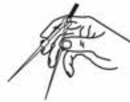
چگونگی تنظیم دهانه‌ی پرگار
