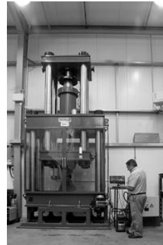
شکل ۳-۹ سامانه های کالیبراسیون لودسل
