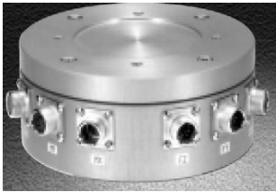
شکل ۲-۱۸ یک لودسل چند محوره
