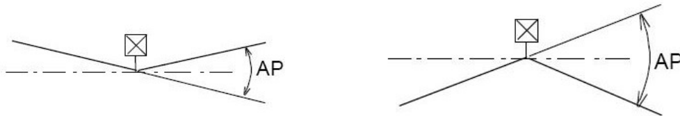
انحراف در جهت داخل تیر
