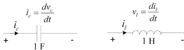
شکل (۱)-۵۱: برداشت معادل سیستمی از دو قانون فیزیکی متفاوت.
