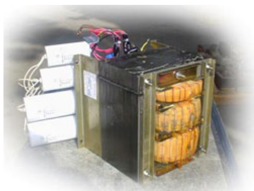
شکل شماره ۶- ترانسفورمر فرورزونانت
