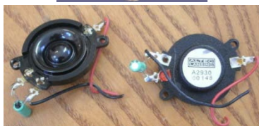
شکل ۵۶- نمایی از بلندگوهای مناسب برای پخش صداهای زیر
