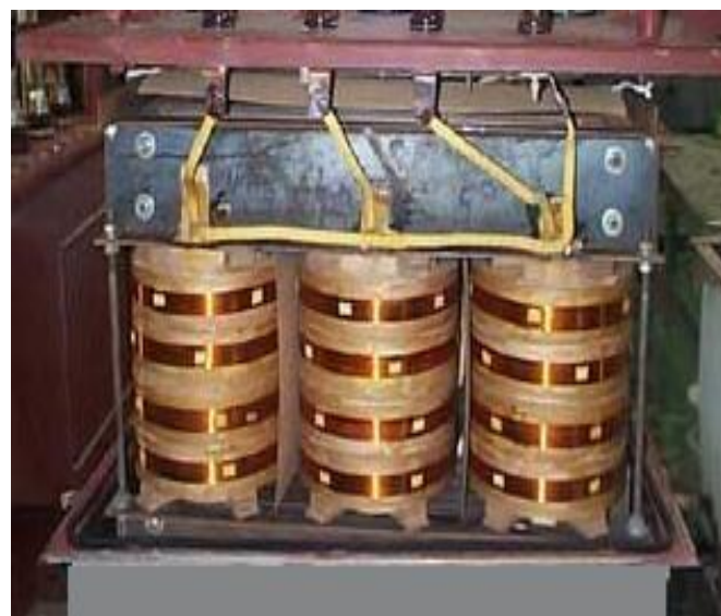
(C) اکتیو پارت (هسته و سیم پیچها)
